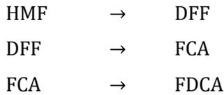
Si nota come in questo caso si tratti di un processo di reazione lineare dove si ha la successione regolare di intermedi di reazione. Per cui non si avranno più reazioni parallele in competizione fra loro ma ciascun composto deriverà da un solo reagente e garantirà la formazione di un unico prodotto.
