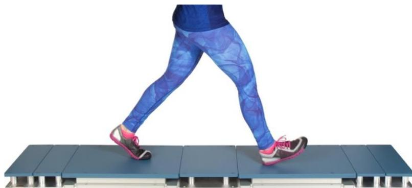
Figure 7 - Esempio di pedane dinamometriche AMTI
