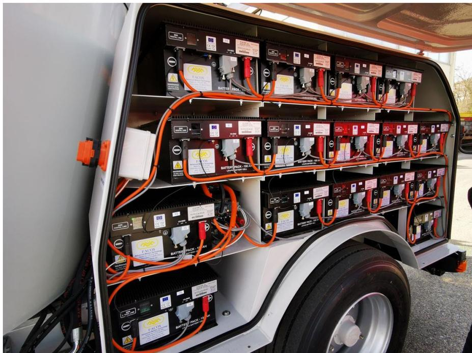
*Figure 2.8. Pacco batterie di Electra2*
