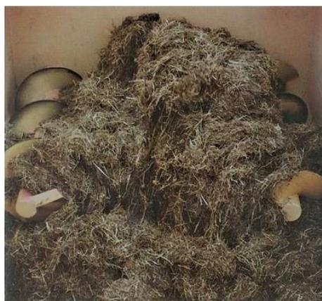
Figure 2.3. Carro trincia miscelatore orizzontale trainato, Supertino
