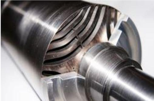
Figure 3.3, rotore di un motore a riluttanza variabile
