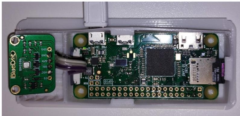
Figura 29: interno del sensore Bosch-Digimat
