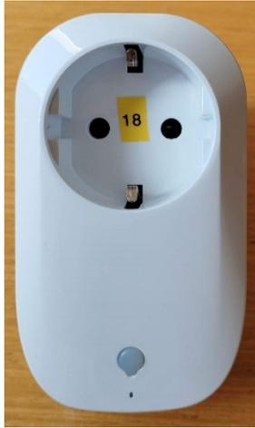
Figura 27: smart plug Shelly per il monitoraggio elettrico dei climatizzatori.
