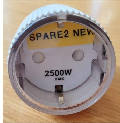
Figura 28: smart plug Shelly per il monitoraggio elettrico delle postazioni di lavoro.
