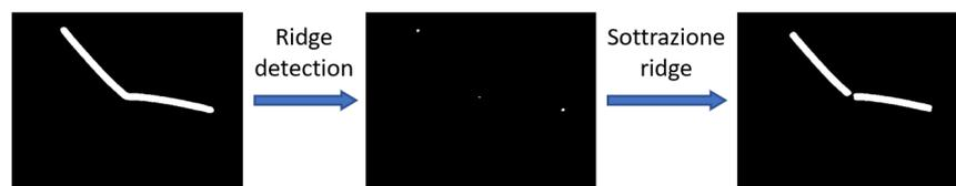
**Figura 3.4.** Esempio di ridge detection con sottrazione dei ridge rilevati.
