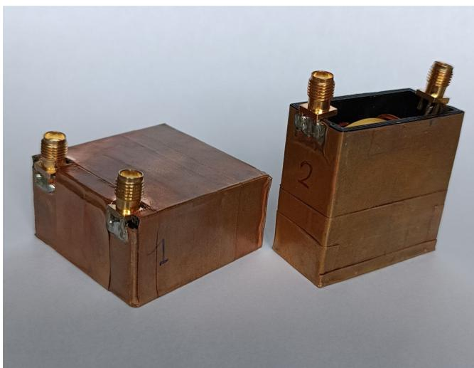
Figura 5.11. Prototipi sperimentali degli induttori realizzati
