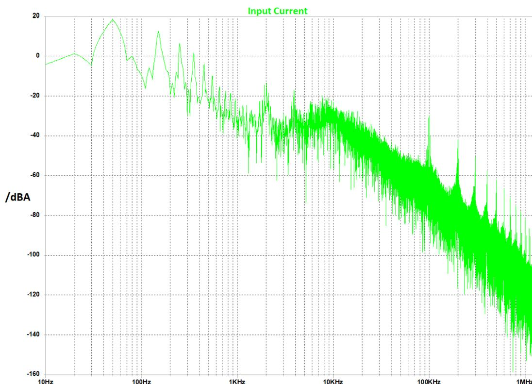
Figura 2.15. FFT della Corrente erogata dalla sorgente nel CPC con  $P_{out} = 1,6kW$
