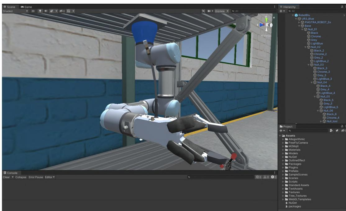
Figura 3.2: Modello di un robot e rispettiva gerarchia all'interno di Unity.
