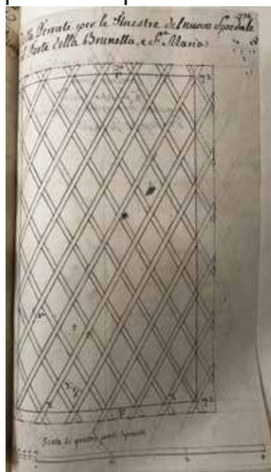
Figura 31 Disegno con istruzioni per la realizzazione delle ferrate per l'ospedale del forte della Brunetta. Le bacchette di spessore 3/4 d'oncia entravano nella muratura alla base per 1 oncia e mezza mentre in altezza per 3 once A.S.To., Sez. riun., Contratti fabbriche e fortificazioni, mazzo 76, 4 Febbraio, 1778, pg. 234.
