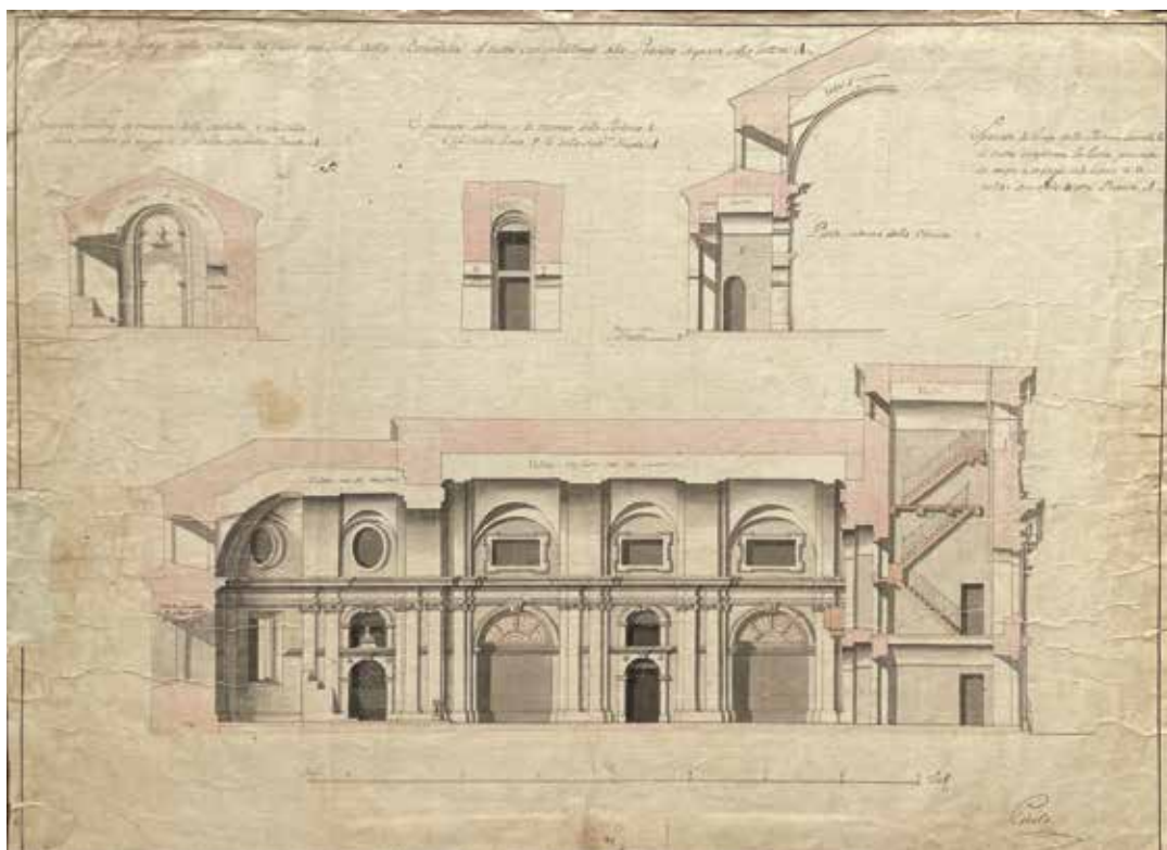
Fig. 81 Sezione trasversale della chiesa, Spaccato di Lungo della chiesa da farsi nel Forte della Brunetta il suo corrispondente alla Pianta segnata colla lettera A., Barri P., ISGAG, Brunetta, Cartella LIX B., nr. 3739
