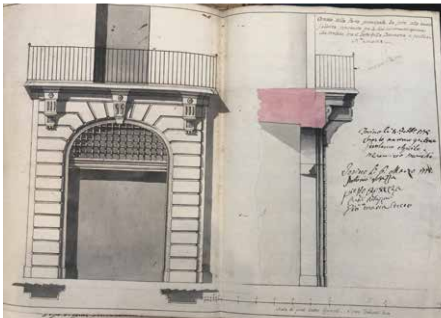
Figura 30 Disegno del Pinto per la realizzazione della porta, con il suo ornato in pietra, della manica occidentale dell'ospedale. A.S.To., Sez. riun., Contratti fabbriche e fortificazioni, mazzo 76, febbraio, 1775, pg. 177.
