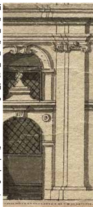
Figura 31 Disegno con istruzioni per la realizzazione delle ferrate per l'ospedale del forte della Brunetta. Le bacchette di spessore 3/4 d'oncia entravano nella muratura alla base per 1 oncia e mezza mentre in altezza per 3 once A.S.To., Sez. riun., Contratti fabbriche e fortificazioni, mazzo 76, 4 Febbraio, 1778, pg. 234.
