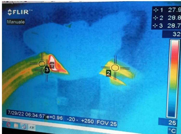
Figura 4.3.1 Campo di temperature sul disco dopo 5 minuti rilevato con termocamera
