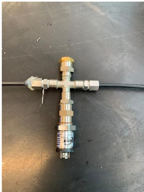
Figura 4.1.5 Il sensore di pressione
