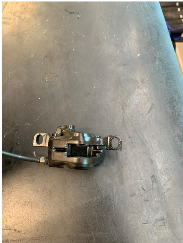
*Figura 3.2.5 Pinza freno, alloggiamento pastiglie*
