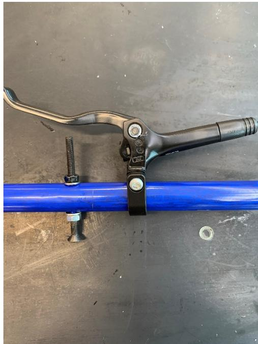
Figura 4.1.7 Fine corsa leva freno
