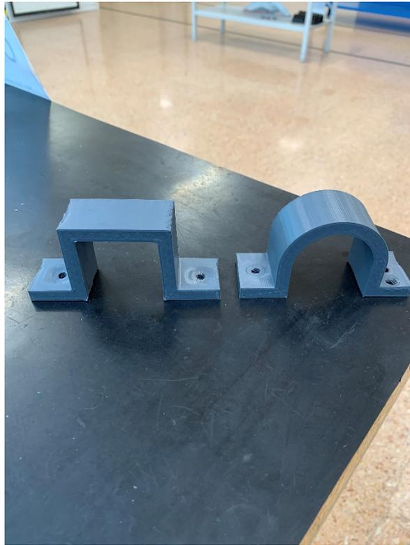
*Figura 3.3.1 Supporti polimerici per il fissaggio del motore*
