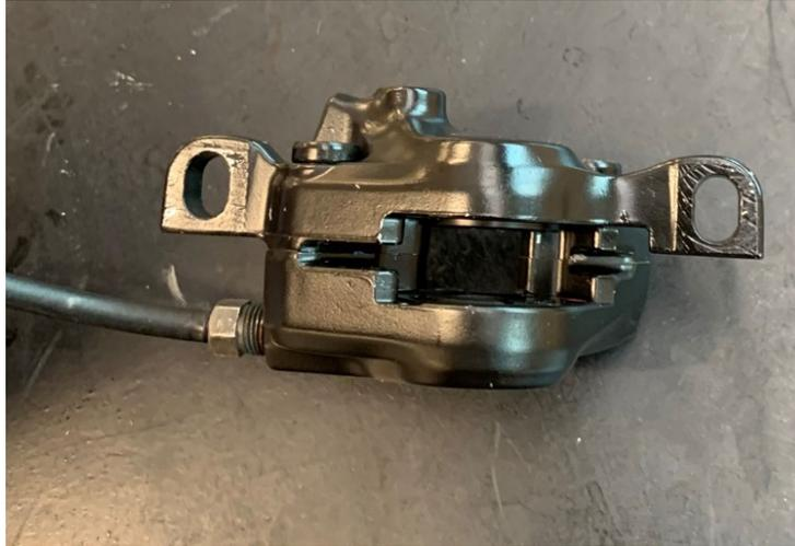
Figura 2.2.2 Pinza freno con alloggiamento pastiglie
