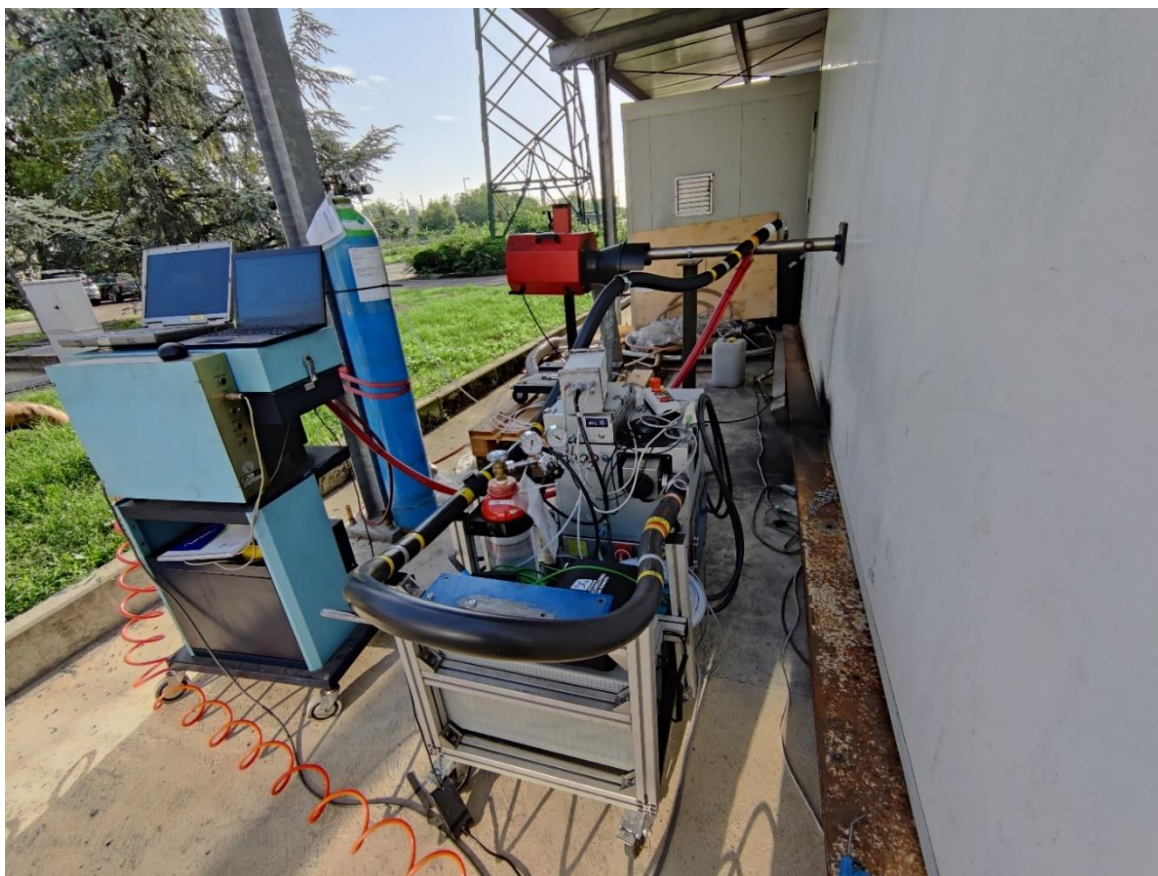
Figura 1: Allestimento della linea di scarico con PEMS, opacimetro e aspiratore.
