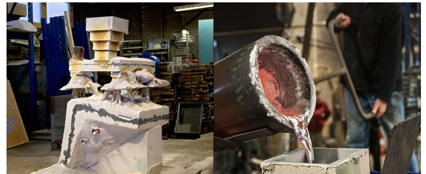
figura 3.3.2 processo di produzione attrav- erso colata in unico stampo della Bone chair
