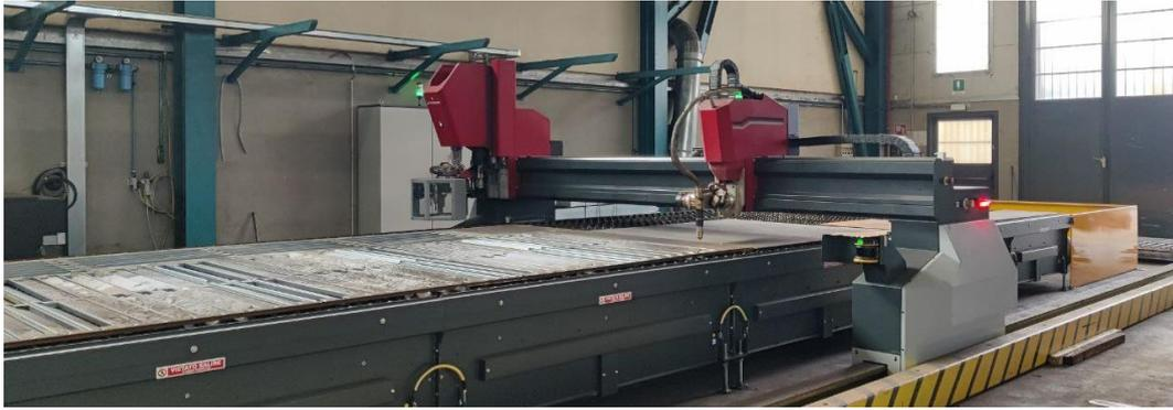
*Figura 117 - Macchina a controllo numerico per il taglio delle piastre, carpenteria Martino*
