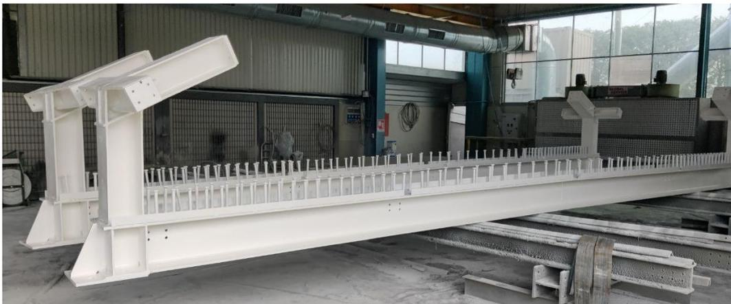
*Figura 118 - Travi con verniciatura intumescente presso la carpenteria Martino*
