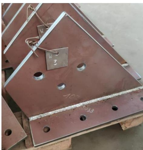
*Figura 115 - Piastre preparate per il processo di zincatura*
