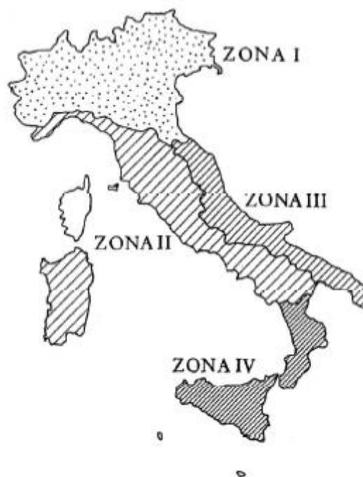
Figura 21 – Zone della temperature dell'aria esterna
