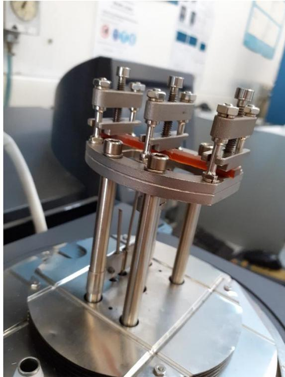
Figura 7. Provino inserito nel dual cantilever bending
