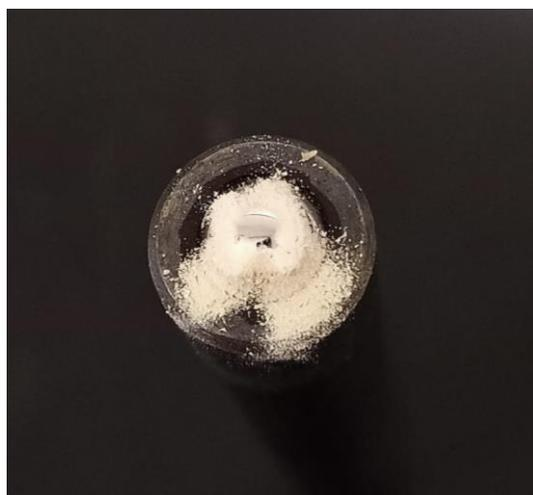
Figura 11. Materiale asportato dal provino EP commerciale durante la prova effettuata con il tribometro
