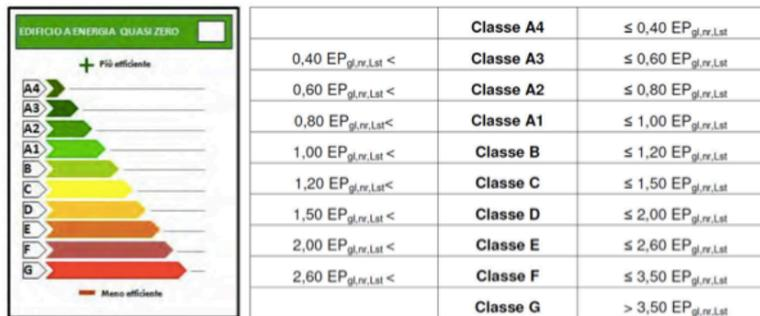
Figura 38. Determinazione della prestazione energetica in relazione all'edificio di riferimento
