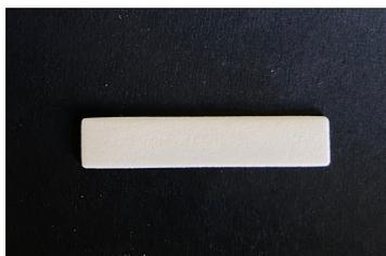
Figura 5.7: Provino in PBAT utilizzato per l'analisi DMA (*SP1\_05*).
