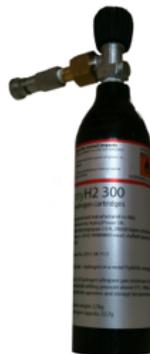
Figura 78: Serbatoio idruri utilizzato nelle prove sperimentali
