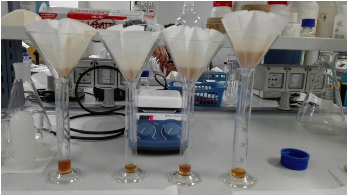
Fig.2.4: Filtrazione con carta filtro Whatman TM , tipo 1, 185mm Ø.
