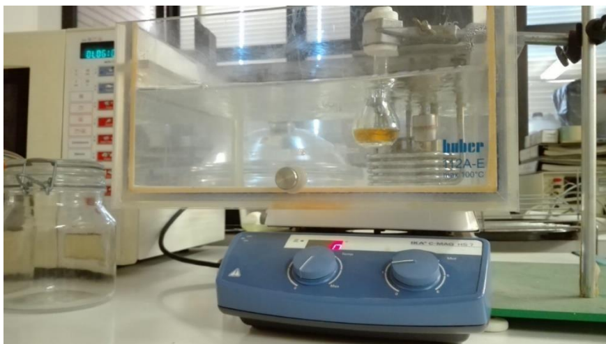
Figura 2.2.: Bagno termostatico per la produzione di film dalle proteine estratte.
