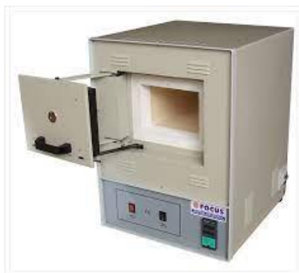
Figura 2.3 Forno a muffola utilizzato per l'indurimento dei campioni.
