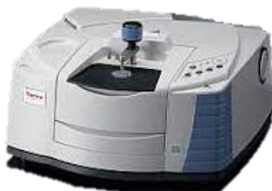
Figura 2.4 Nicolet iS50, spettrometro utilizzato per l'analisi FT-IR.
