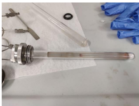
Figura 6.3 Reattore con all'interno il catalizzatore e la lana di quarzo
