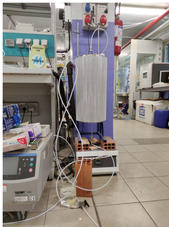
Figura 5.6 Reattore di quarzo posizionato nel forno verticale con temperatura programmabile
