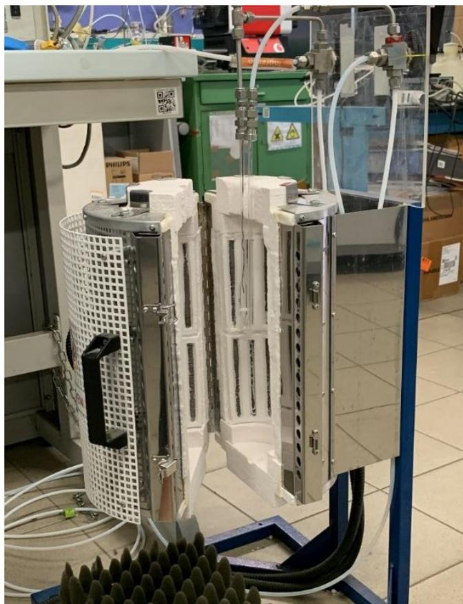
**Figura 5.12** Reattore collegato al forno LTF.
