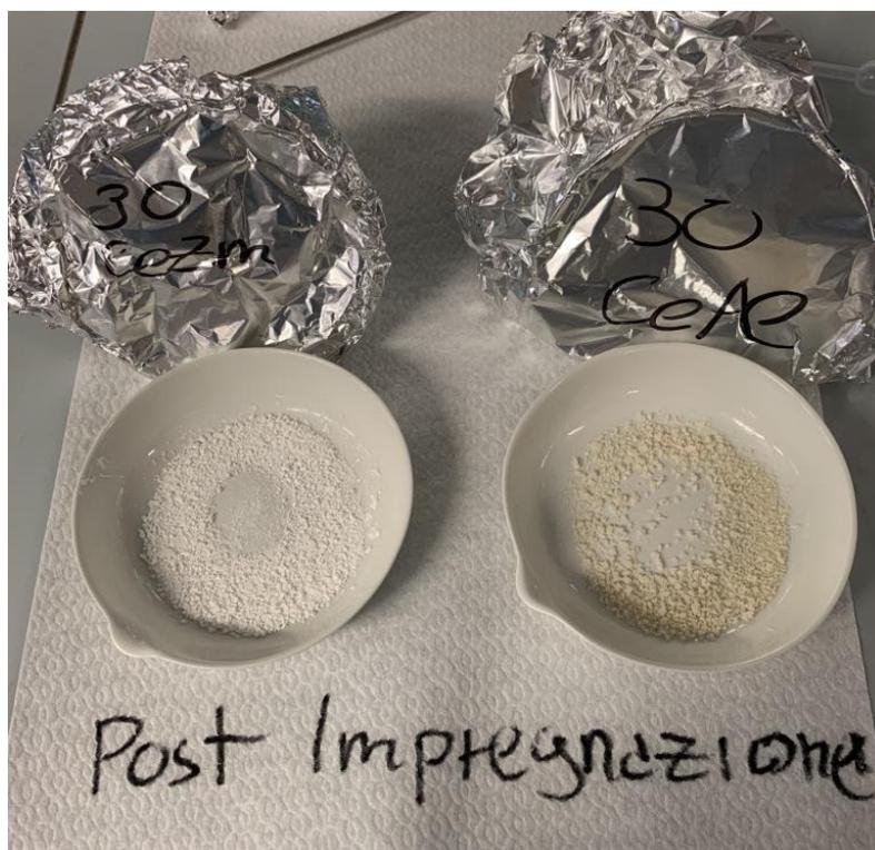
**Figura 10.1** 30CEZM e 30CEAL dopo la sintesi tramite impregnazione.
