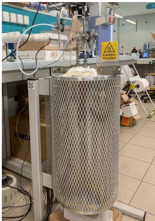
Figura 5.15 Reattore collegato al forno.
