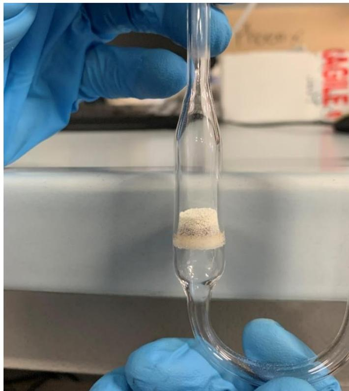
**Figura 5.11** Particolare della fase adsorbente caricata nel reattore ad "U".
