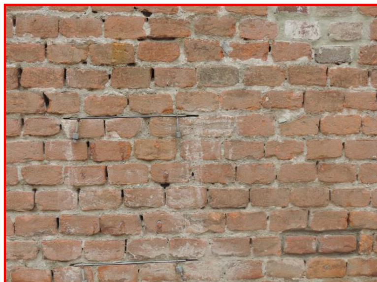
FOTOGRAFIA 171 – I MARTINETTI PIATTI DOPPI PER LA PROVA DI DEFORMABILITÀ E RESISTENZA DELLA MURATURA
