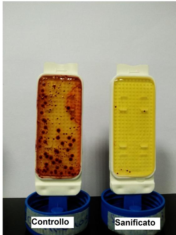
Figura 4.20: Sulla sinistra, contact slide di riferimento dell'acqua contaminata. Sulla destra, contact slide del campione sanificato con il prototipo.
