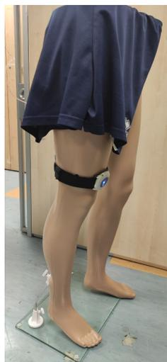
FIGURA 3.3: Posizionamento del sensore REMO.
