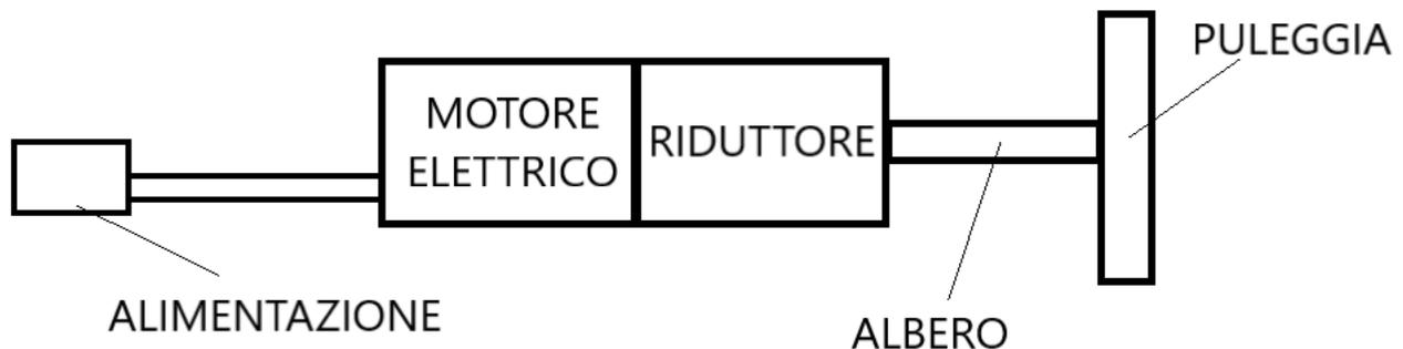
Figura 57. Schema del sistema di attuazione
