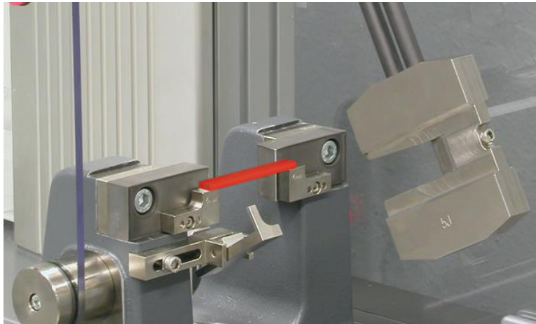
Schematizzazione prova d'impatto Charpy
