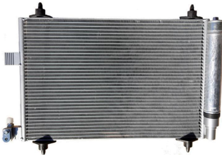
*Figura 3.4: Condensatore*
