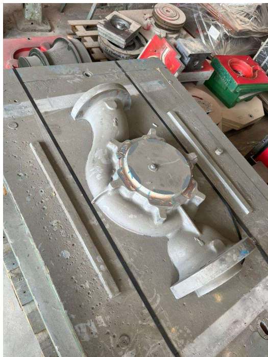
Figura 11 – Esempio di placcamodello di un corpo pompa
