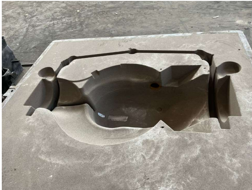
Figura 13 – Esempio formatura a resina di un modello di corpo pompa
