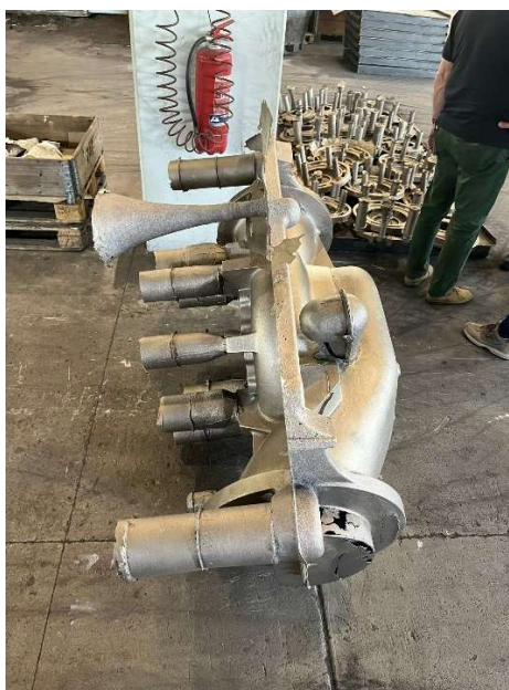
Figura 16 – Getto di fusione di un corpo pompa dopo la disterratura
