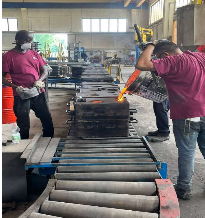
Figura 14 – Linea di formatura automatica (fase di colata)
