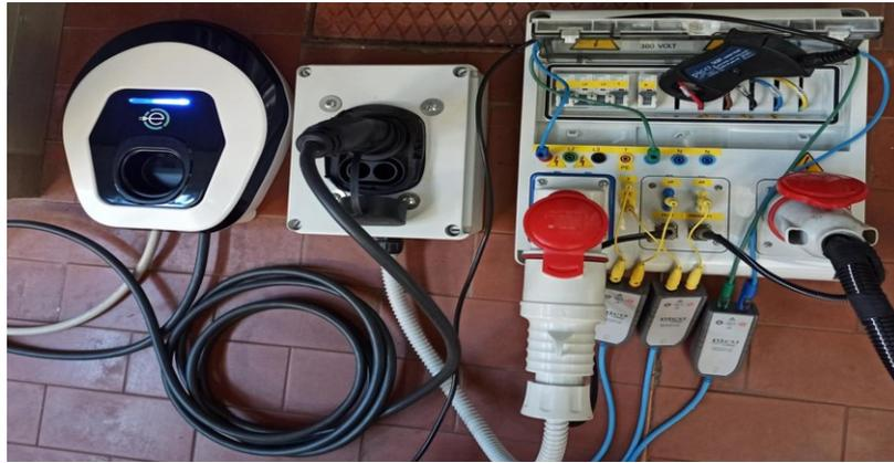
Figura 2.10. Setup Break Out Box
