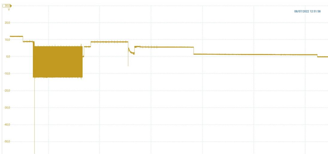
Figura 3.56. Andamento segnale pilota durante la fase di Blackout Wallbox 2 - Veicolo A
