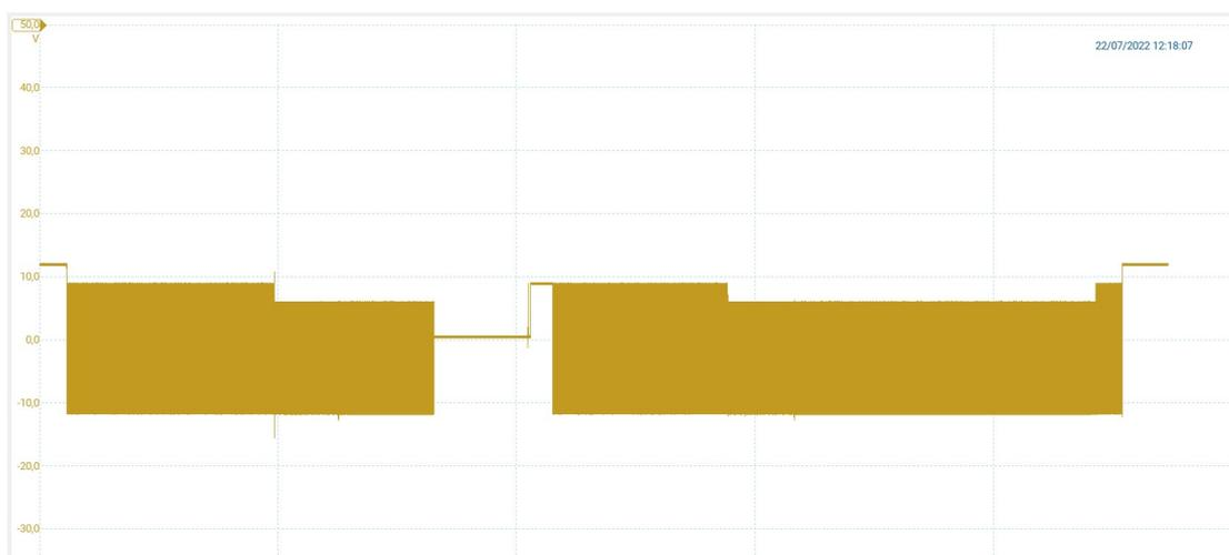
Figura 3.127. Andamento segnale pilota durante e post blackout Wallbox 3 - Veicolo C
