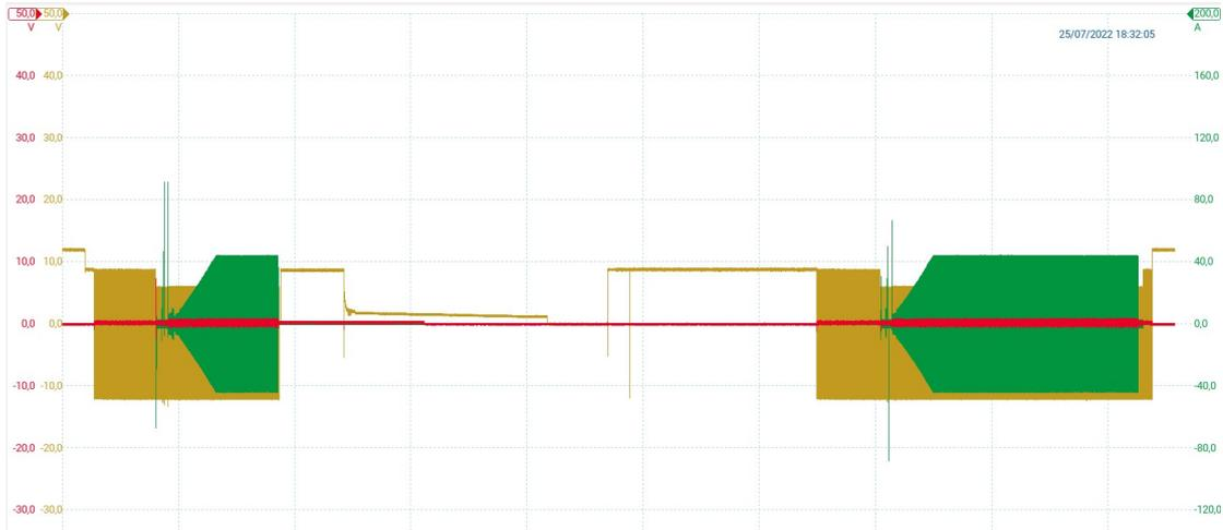
Figura 3.70. Andamento ricarica durante blackout Wallbox 2 - Profilo corrente, PP, CP - Veicolo B
