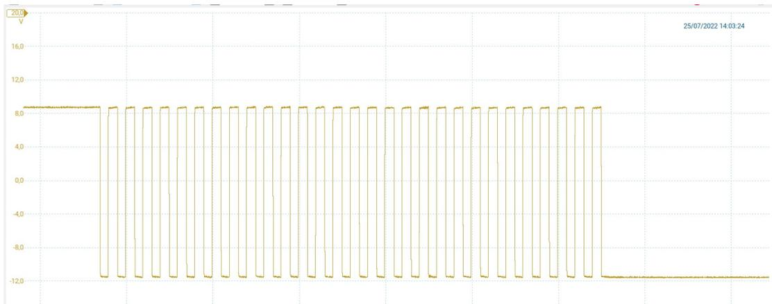
Figura 3.81. Stato B2 segnale pilota Wallbox 2 - Veicolo C
