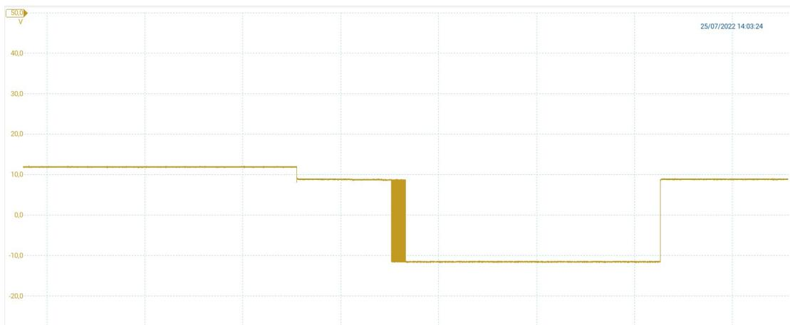
Figura 3.80. Stato A e B1 segnale pilota Wallbox 2 - Veicolo C
