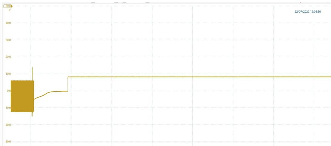
Figura 3.97. Andamento segnale pilota durante blackout Wallbox 3 - Veicolo A
