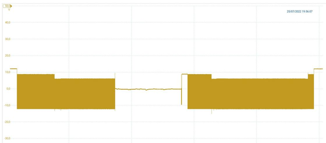
Figura 3.113. Andamento segnale pilota durante e post blackout Wallbox 3 - Veicolo B
