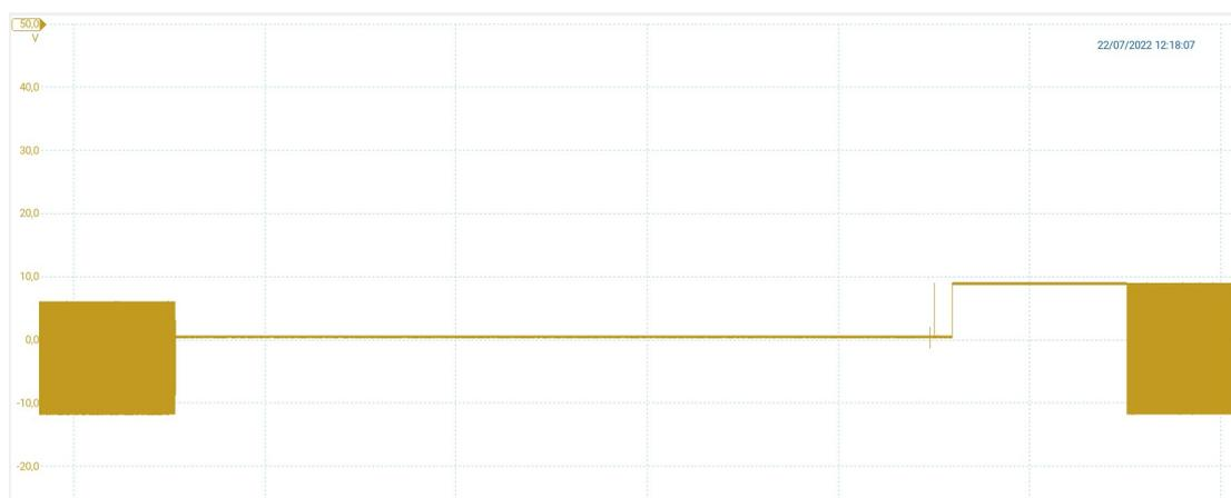
Figura 3.129. Andamento segnale pilota durante blackout Wallbox 3 - Veicolo C
