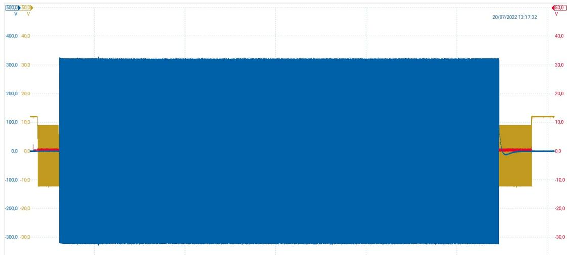
Figura 3.84. Andamento ricarica Wallbox 3 - Profilo tensione, PP, CP - Veicolo A
