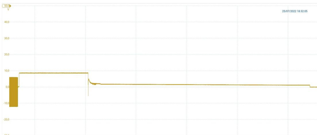
Figura 3.74. Andamento segnale pilota durante blackout Wallbox 2 - Veicolo B
