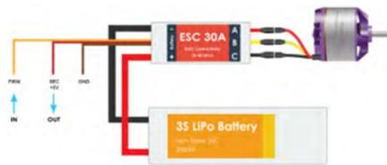
Figura 1.17: Schema di collegamento dell'ESC
