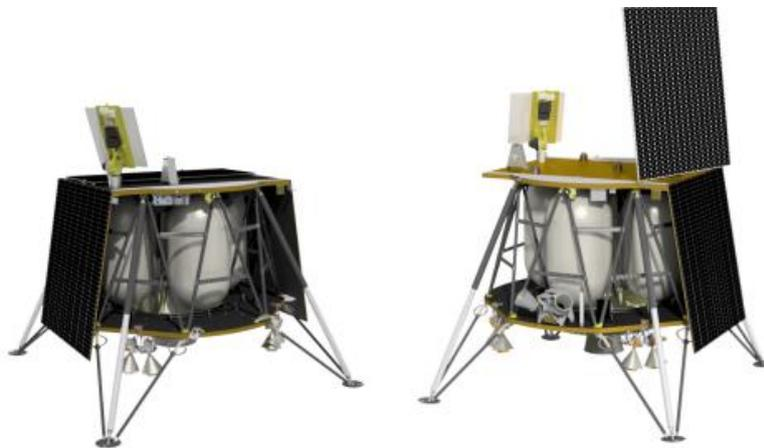
*Figura 2.12: Blue Ghost Lander sviluppato per la missione TO 19D, a sinistra la configurazione con tre pannelli solari fissi per landing site, a destra il dispiegamento dei pannelli per seguire il Sun Vector anche nelle zone polari, credits by Firefly Aerospace*
