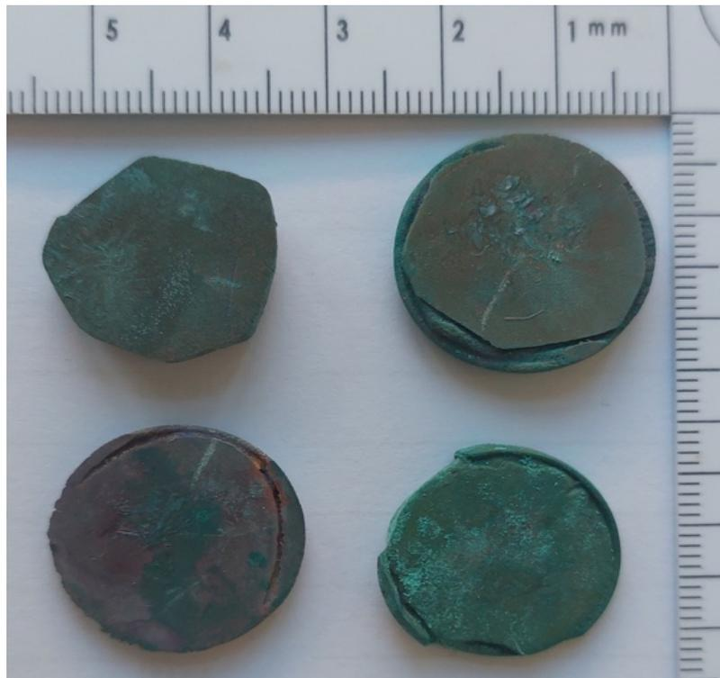
Figura 2.11: Campioni con patina a base di solfati ottenuta per immersione.
