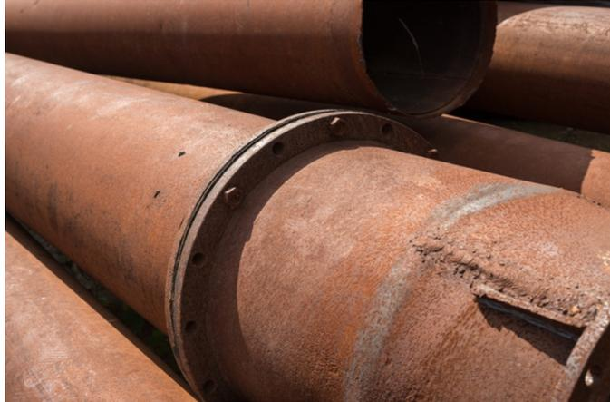
*Figura 1.2: Esempio di corrosione uniforme di una tubatura.<sup>[2]</sup>*
