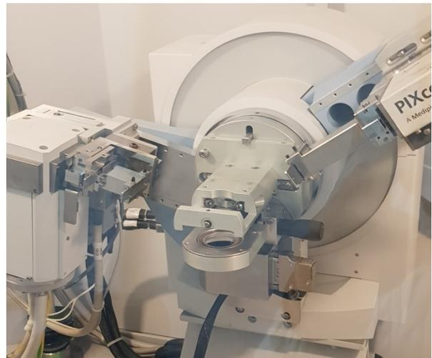
Figura 2.20: Diffratometro a raggi X
