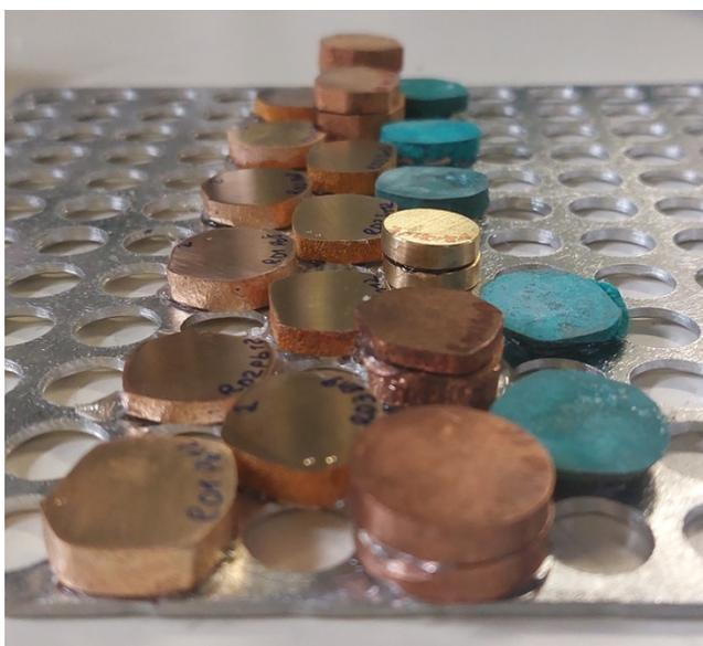
Figura 2.26: Campioni posizionati sull'apposito carrello portacampioni e pronti per essere analizzati.
