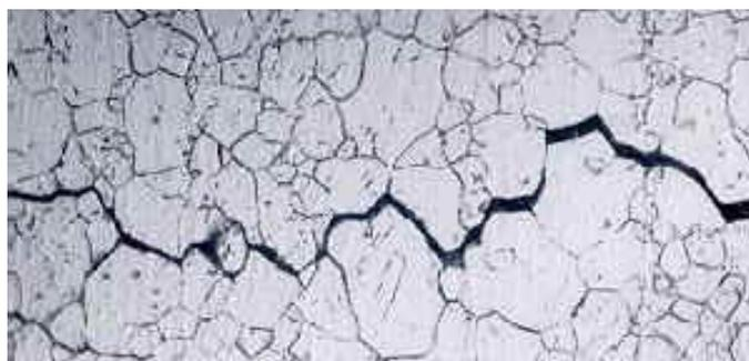
Figura 1.6: Esempio di linea di frattura dovuta a *stress corrosion cracking*.<sup>[5]</sup>
