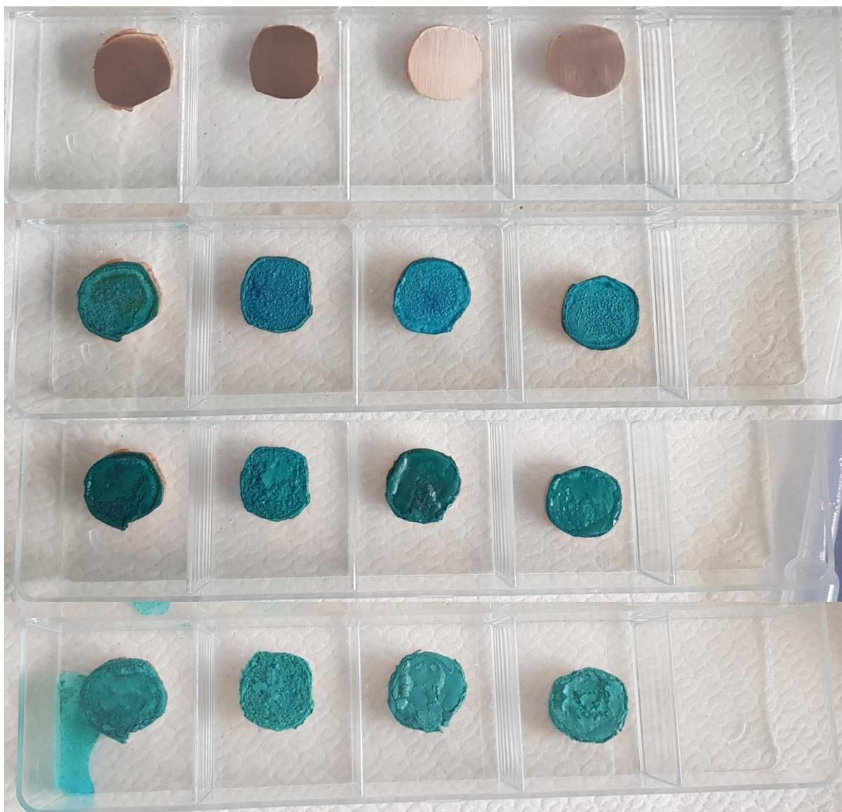
Figura 2.9: Evoluzione temporale dei campioni con patina a base di cloruri ottenuta mediante una pipetta.
