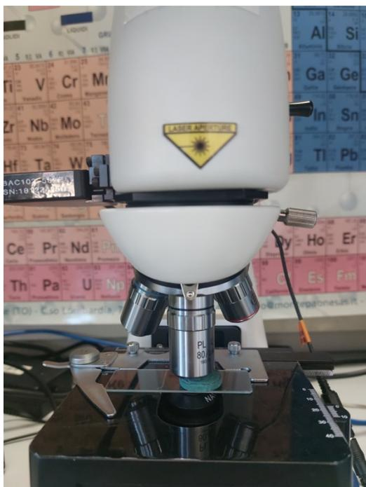
Figura 2.17: Microscopio per l'analisi Raman
