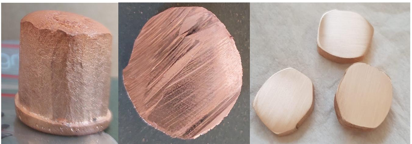
Figura 2.2: a) Lingotti di lega; b) Dischetto ottenuto dopo il taglio; c) Campioni lucidati.
