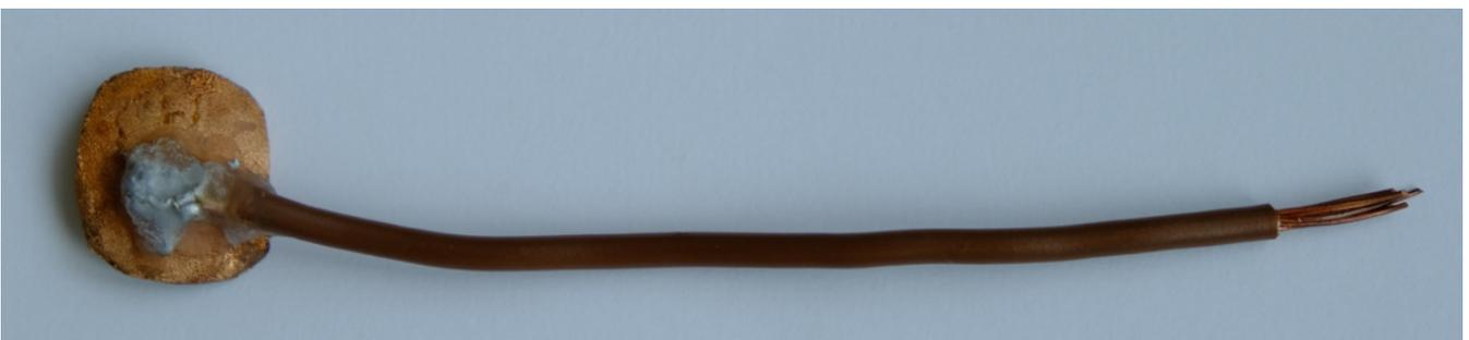
Figura 2.14: Campione saldato ad un cavo elettrico.
