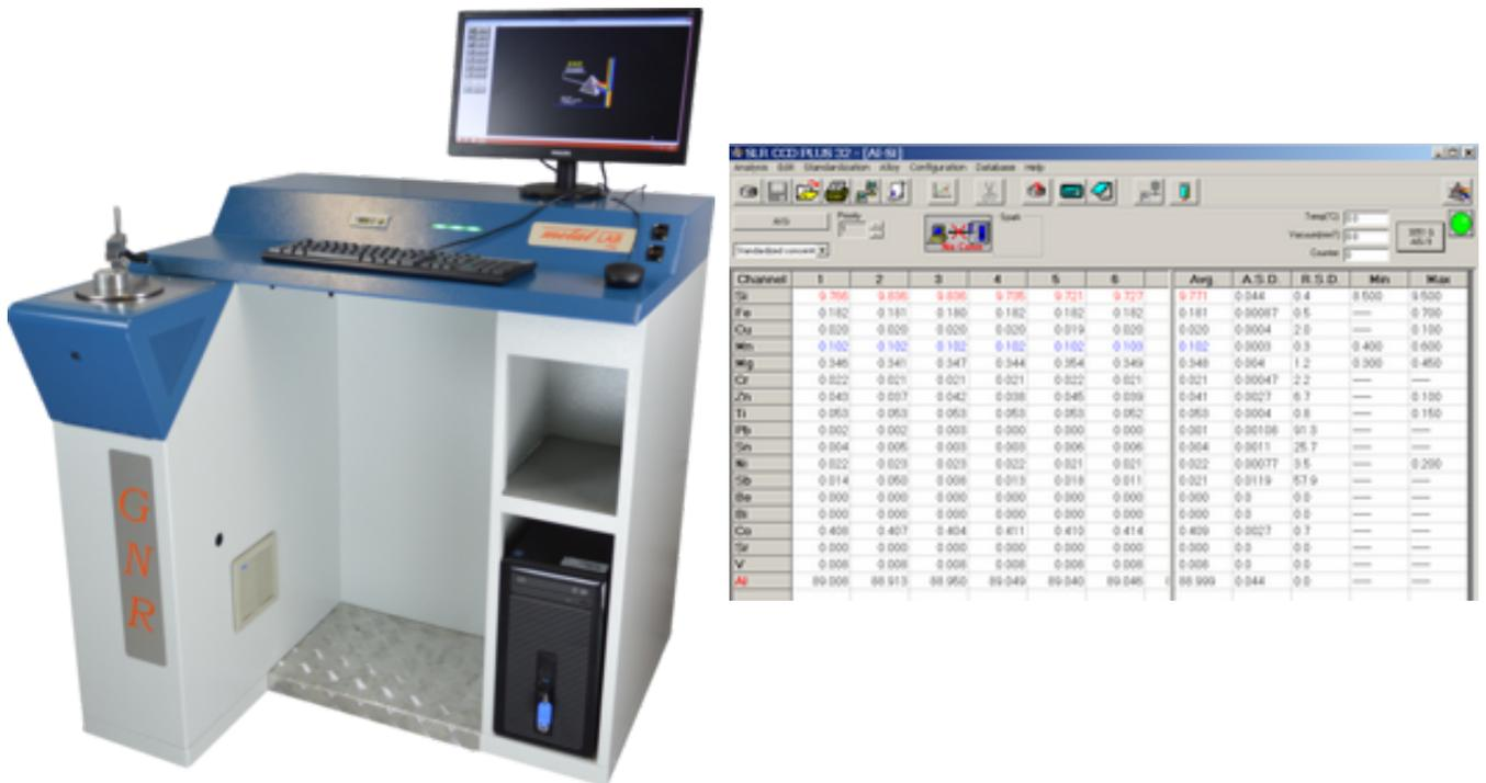
Figura 1.18: Spettrometro ad emissione ottica S7-Metal Lab Plus e relativa interfaccia grafica. [14]
