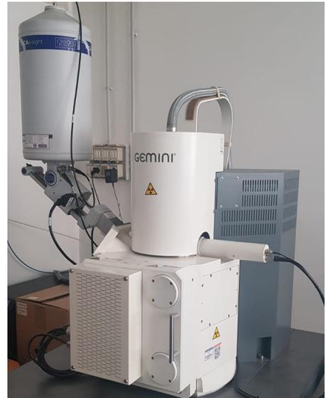
Figura 2.24: Microscopio a scansione elettronica (SEM).
