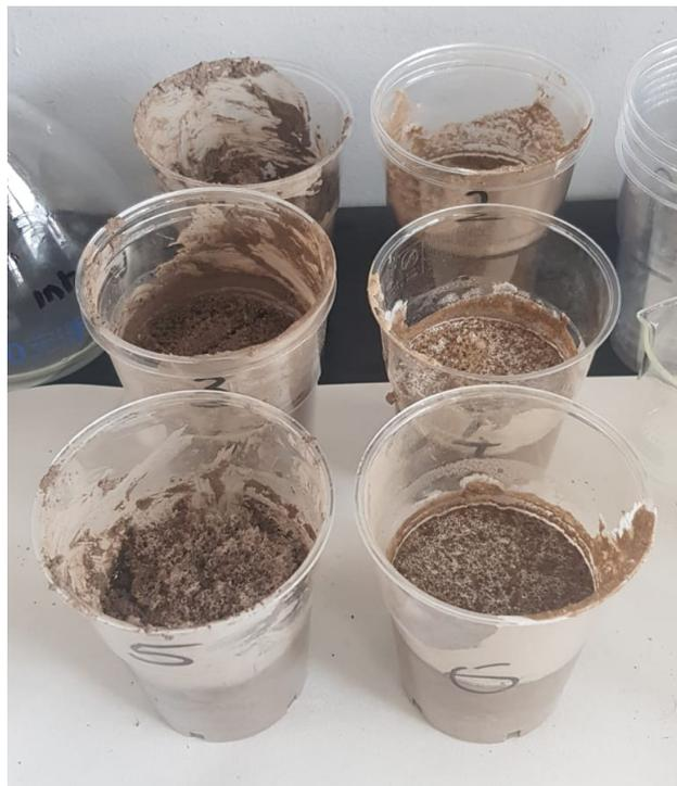
Figura 2.16: Setup per la produzione di patine su campioni interrati.
