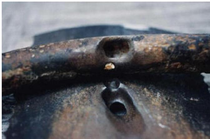
*Figura 1.3: Esempio di corrosione per pitting di una tubatura. La rottura di questa condotta avvenuta nel 1992 a Guadalajara, Messico, ha portato alla morte di più di 200 persone e danni per alcune decine di milioni di dollari.<sup>[3]</sup>*
