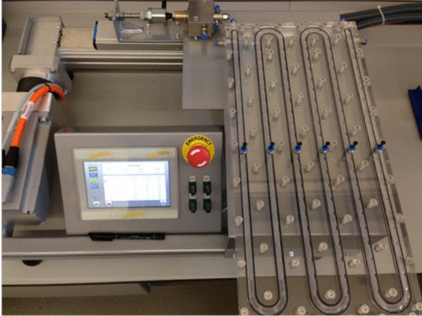
**Figura 3.2:** Fotografia di un reattore oscillatorio da laboratorio (Cruz et al. 2021)
