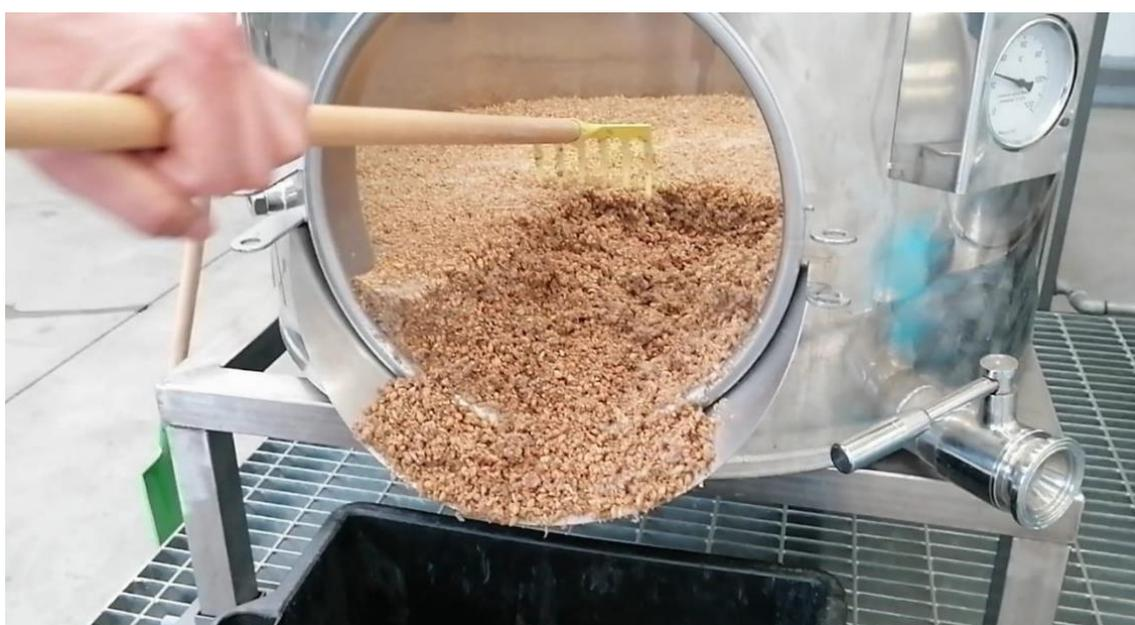
*Figura 2.1.2* – Rimozione del BSG *Forna* al termine del processo di *filtrazione e sparging*
