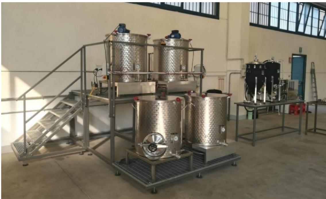
*Figura 2.1.1* – Sala cottura dell'impianto utilizzato per produrre il BSG *Forna*
