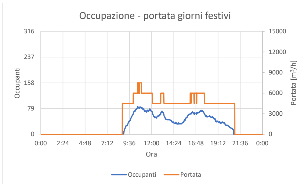
Figura 29 - Curva di regolazione della portata per i giorni festivi (teorica)
