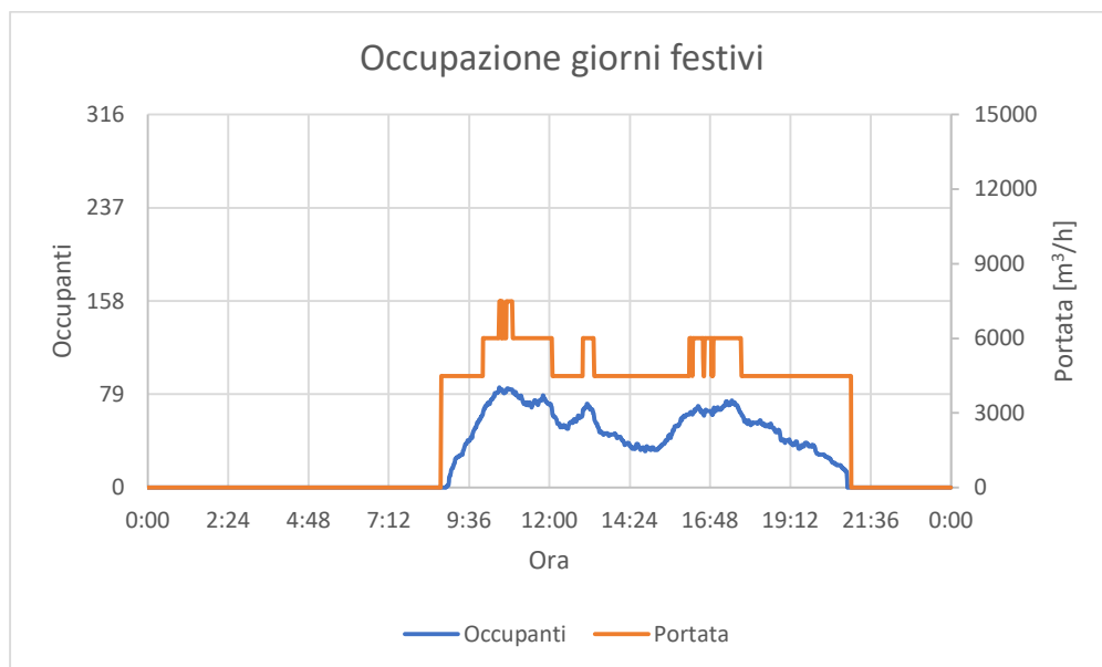
Figura 34 - Curva di regolazione della portata per i giorni festivi (costruita sui dati misurati)
