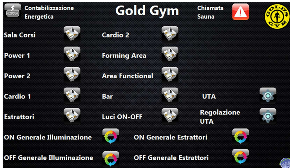
Figura 18 - Schermata di controllo del software che permette la gestione energetica nella palestra Gold's Gym di Milano (Home)
