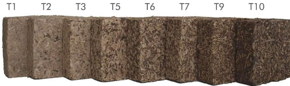
**Figura 2.** Campioni realizzati con composizione percentuale di cippato di ulivo crescente
