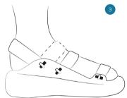
Sutti i componenti sono prodotti tramite stampa 3D, il giunto lacci-suola viene risolto con il sistema perno-asola.
