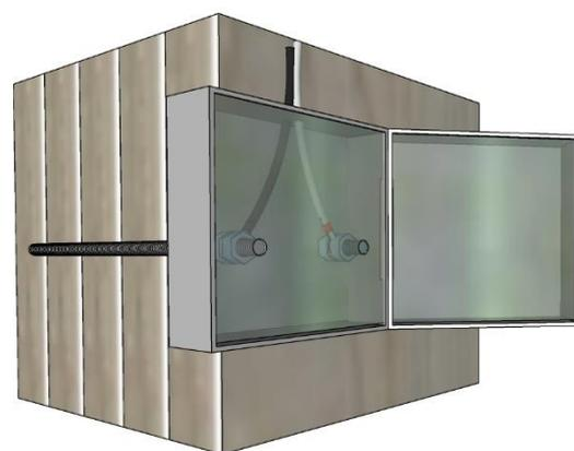
Figura 105. Le immagini riportano il posizionamento di un sensore MySenseBus in una parete in CLT. I sensori vengono posizionati ad un'altezza di 6 cm al centro della tavola. Le viti possono essere inserite ad una profondità variabile in base allo spessore del pannello. (fonte: immagini elaborate da Diego Savio, responsabile commerciale di Wood Control)
