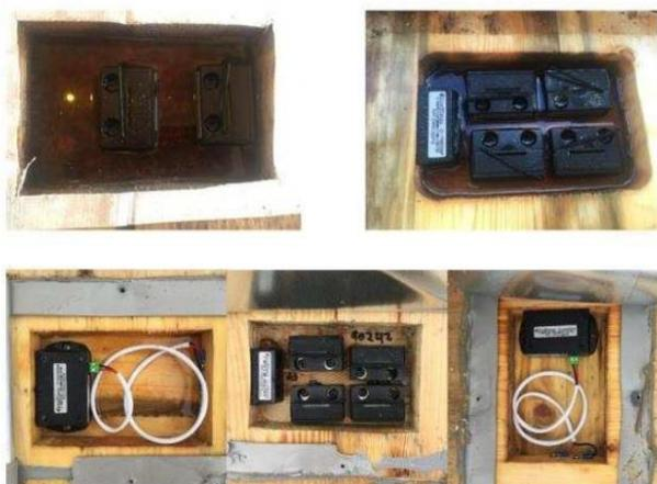
Figura 56. Fotografia di alcuni sensori danneggiati dal mal tempo (fonte: S. Kordziel, Study of moisture conditions in a multi-story mass timber building through the use of sensors and wufi hygrothermal modeling, tesi magistrale, Colorado School of Mines, 2018, relatore: Dr. Shiling Pei.)
