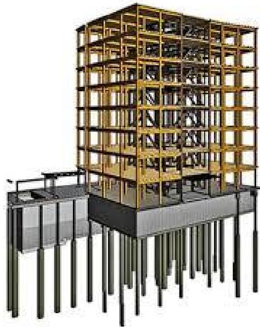
Figura 48. Rappresentazione del sistema strutturale e delle fondazioni (fonte: <https://www.carbon12pdx.com/about>)
