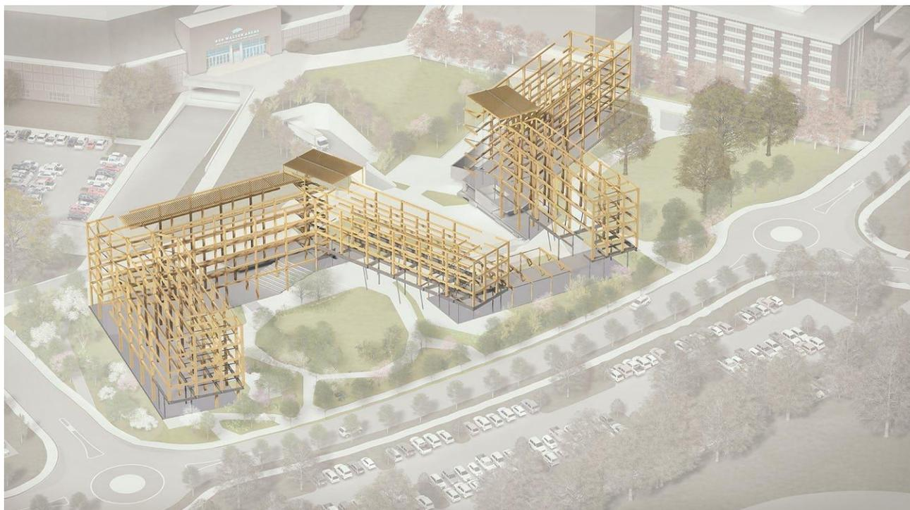
Figura 77. Vista del telaio ligneo e delle solette delle coperture.
