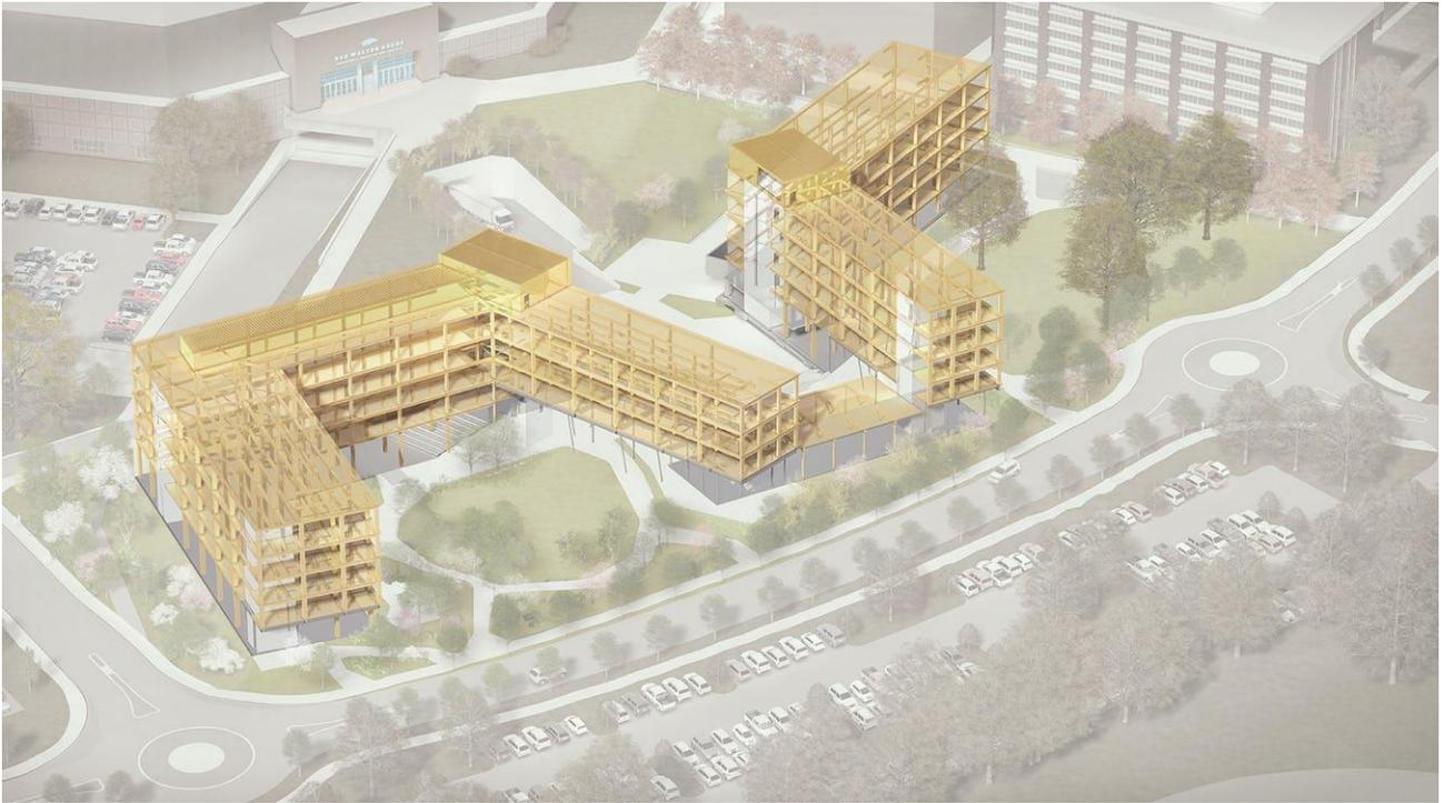
Figura 78. Vista della struttura portante dell'edificio, composta da pannelli, travi e colonne in CLT e vani ascensori e vani scala in cemento. (fonte: <https://www.theolinstudio.com/university-of-arkansas-adohi-hall>)
