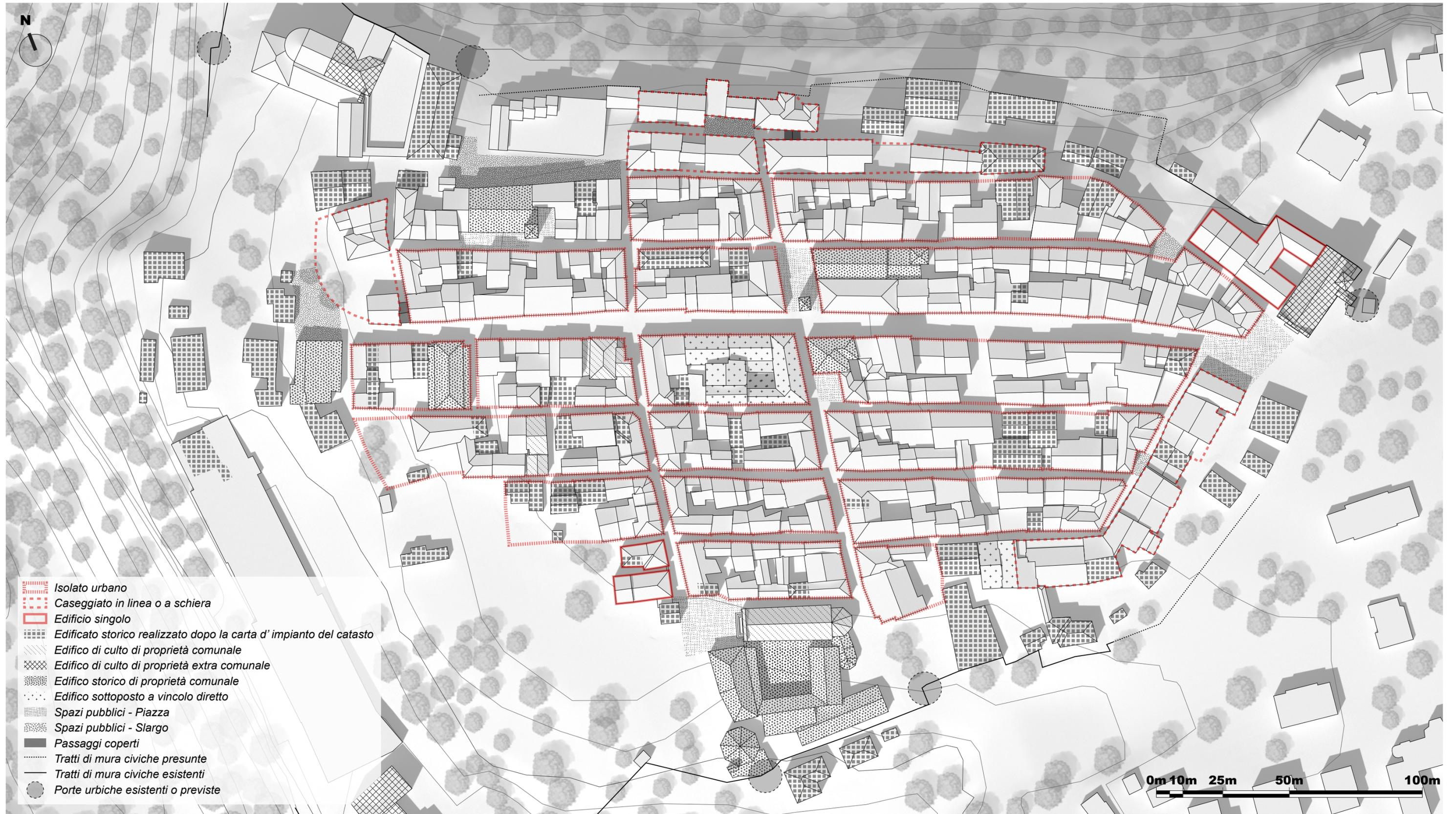
Figura 4.10 - Planivolumetrico dello stato di fatto ante sisma, recante informazioni riguardo la morfologia dei volumi costruiti e i caratteri dello spazio aperto. I dati sono stati estratti dall'elaborato 2.2.3 del PSR con oggetto "Analisi Tipo-Morfologica del centro abitato storico di Amatrice"
