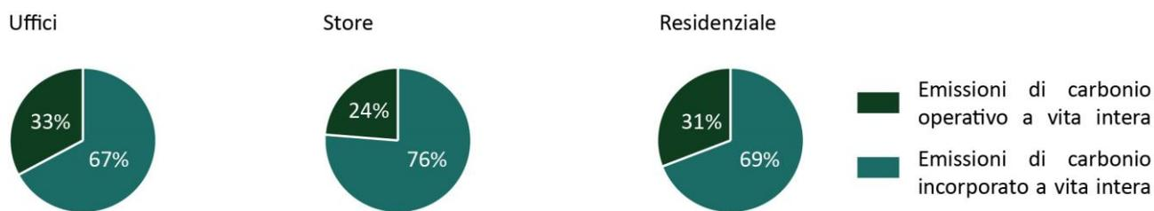
Figure 64\_ Emissioni di carbonio operativo e incorporato. Rielaborazione di Palumbo e Sanna.
