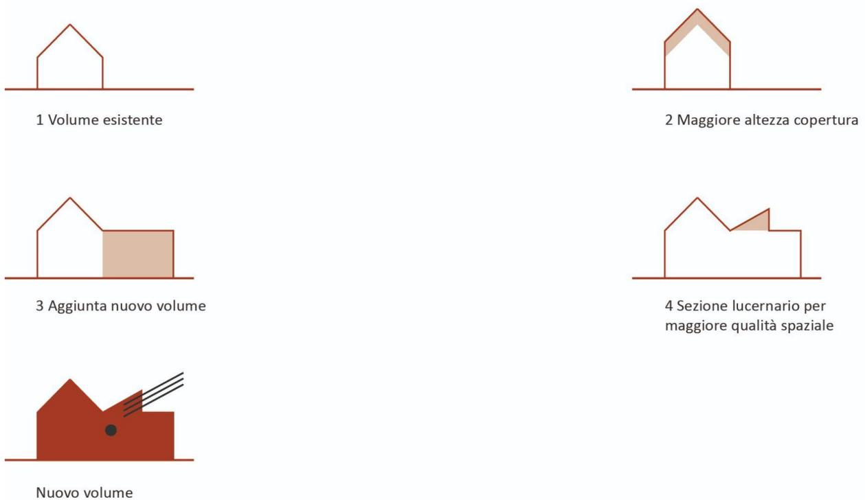
Figura 113\_ Evoluzione del progetto di riqualificazione e ampliamento. Rielaborazione di Palumbo e Sanna.
