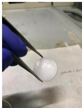
Figura 55: Disco in UHMWPE immerso nell'EO al 100%
