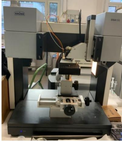
Figura 38: Drop Shape Analyzer 100 E, Krüss
