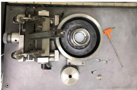
Figura 49: UHMWPE posto nel porta campioni per la prova tribologica
