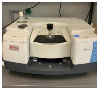
Figure 41: Spettrometro Nicolet™ iS50 FTIR
