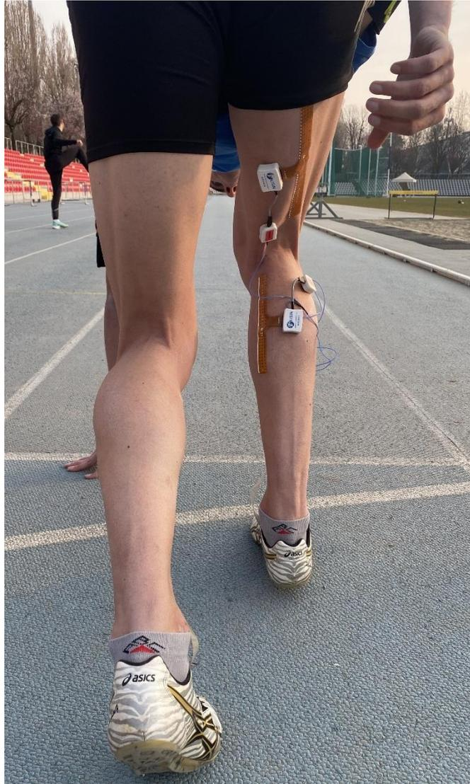
*Figura 19 posizionamento delle matrici di elettrodi e dei due amplificatori su gastrocnemio e bicipite femorale di un soggetto dello studio*
