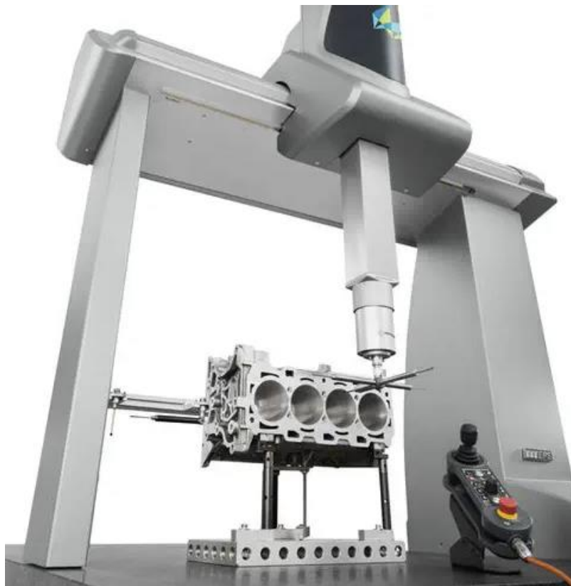
Figura 12 – Esempio di macchina di misura a coordinate della Hexagon in funzione: si tratta in questo caso specifico di una Global S con tastatore con stili multipli.
