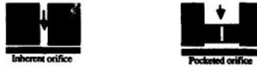
**Figura 1.5:** Esempio di inherently e orifice(pocketed) compensated
