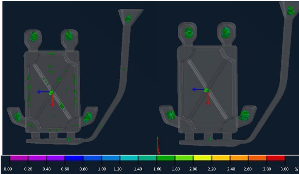
Figura 139 - porosità superiori a 1,6% - conchiglia raffreddata artificialmente (sinistra) e convenzionale (destra) – alla fine dell'ultimo ciclo
