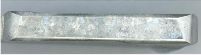
Figura 93 - campione zona sottile - dopo attacco chimico
