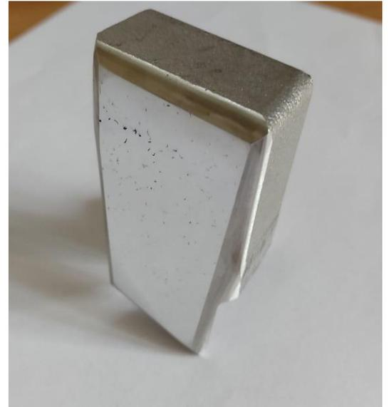
Figura 73 - provino 2: parte massiccia – dimensioni 35x65mm
