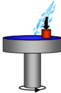
Figura 75 - schematizzazione del processo di levigatura e lucidatura
