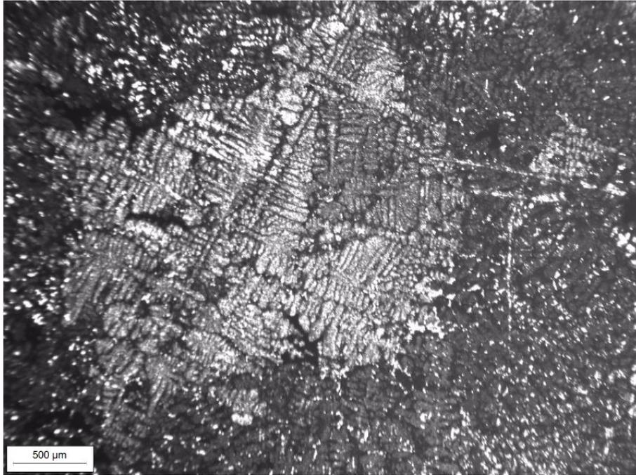
*Figura 97 - grano cristallino - zona massiccia dopo attacco chimico – ingrandimento 2x1*
