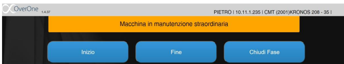
Figura 4.16 Banner che segnala che il macchinario è in manutenzione straordinaria e pertanto non può essere utilizzato.
