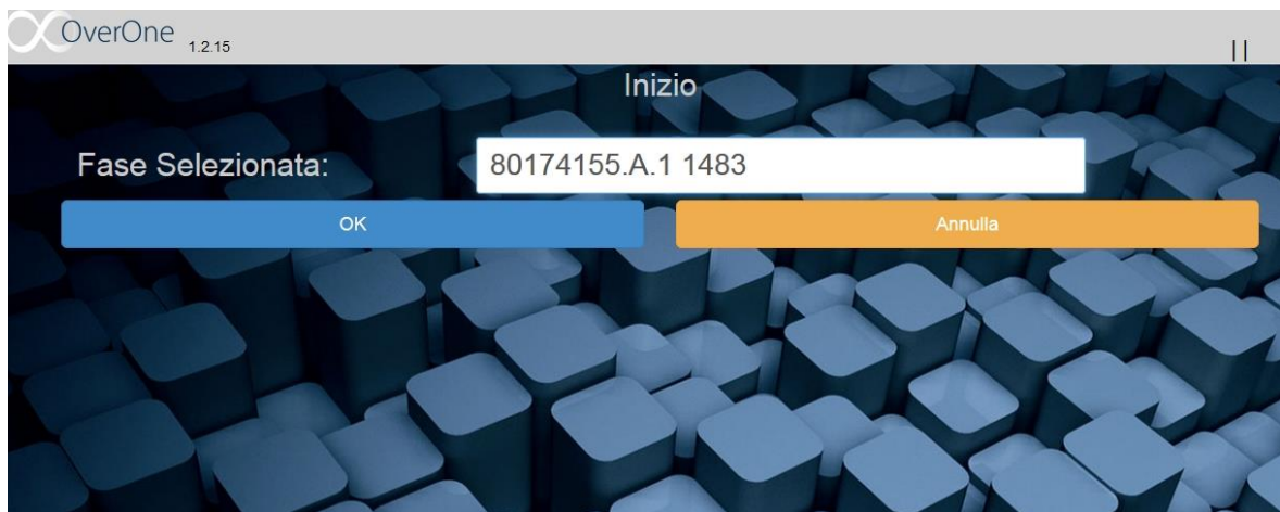
Figura 4.7 Schermata di inserimento della fase. Si può sia digitare manualmente l'intero codice (può capitare quando i codici a barre sui cartellini sono sfuocati o sporchi di olio) oppure acquisirli tramite le apposite pistole.
