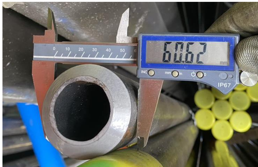
Figura 36: Misurazione con calibro digitale
