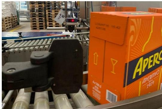
*Figura 28. Fotocellule rilevanti la presenza delle scatole*
