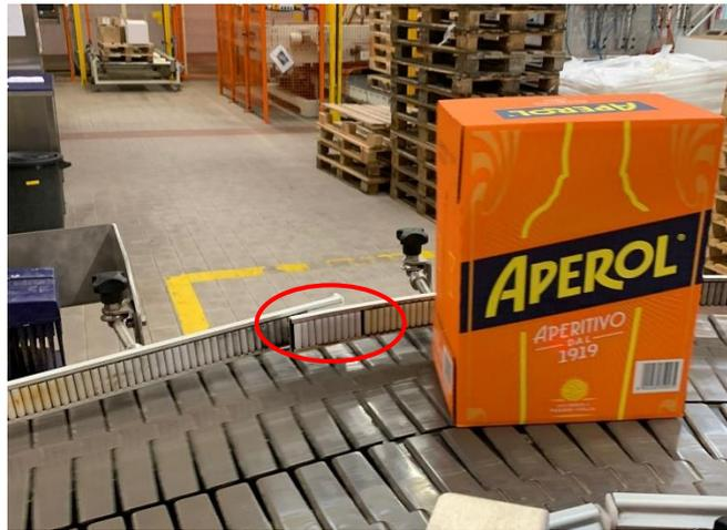
Figura 50. Inserimento dei rullini mancanti sulle sponde per il corretto avanzamento dei cartoni
