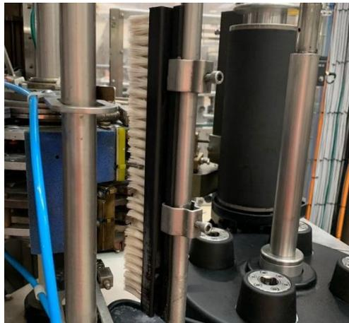
*Figura 21. Spazzole che permettono la pulizia e lucidatura delle etichette*
