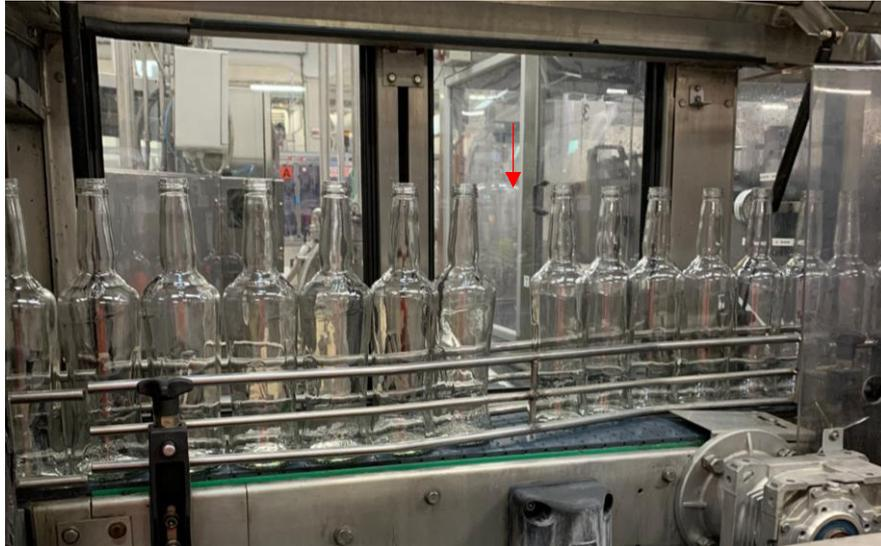
*Figura 40. Mancanza di bottiglie nel regolare flusso lungo i nastri*
