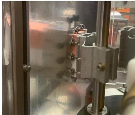
Figura 22. Palette che permettono l'incollatura delle etichette sulla bottiglia
