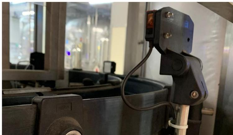
*Figura 39. Fotocellula per rilevare la corretta presenza di bottiglie*
