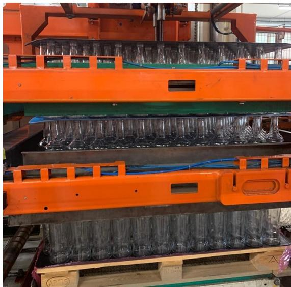
*Figura 17. Centratore che permette il compattamento del piano di bottiglie e l’avanzamento*
