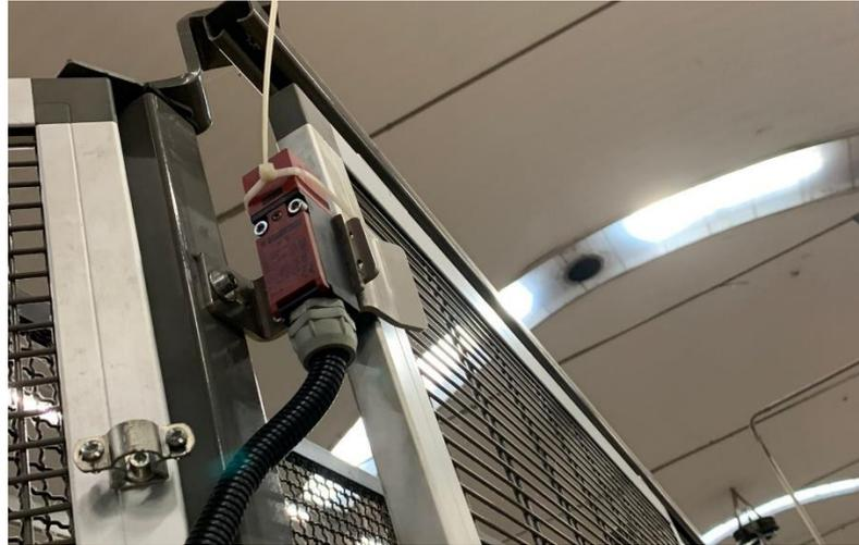
*Figura 48. Microinterruttore della porta del pallettizzatore avvolto da una fascetta*
