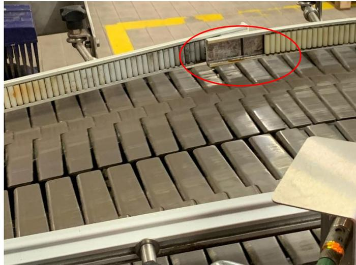
*Figura 46. Rullini mancanti nelle sponde in uscita dalla macchina incartonatrice*
