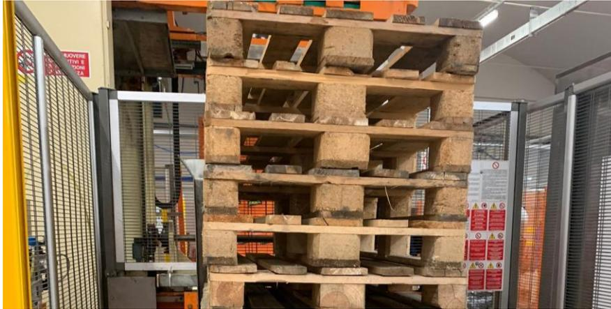
*Figura 47. Pallet impilati che superano in altezza le barriere d'ingresso*
