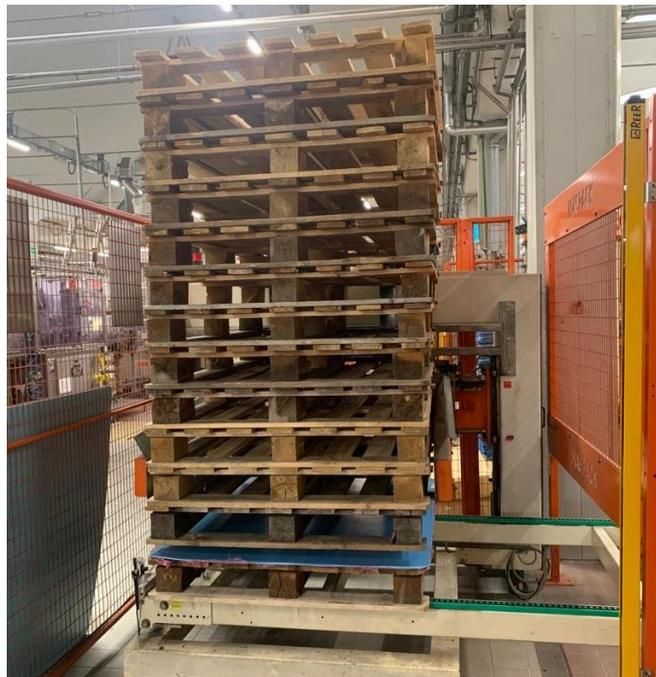
*Figura 16. Zona di accatastamento dei pallet vuoti a lato della macchina*
