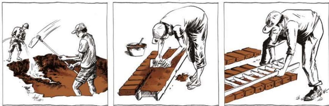
I mattoni crudi sono in grado di garantire una funzione portante, a seconda della dimensione dei mattoni stessi e della loro disposizione.
