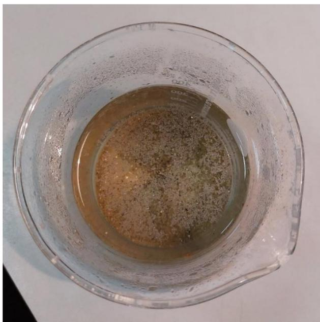
Figura 39. Separazione gravimetrica di un campione di sedimenti sabbiosi per mezzo di soluzione salina con NaCl.
