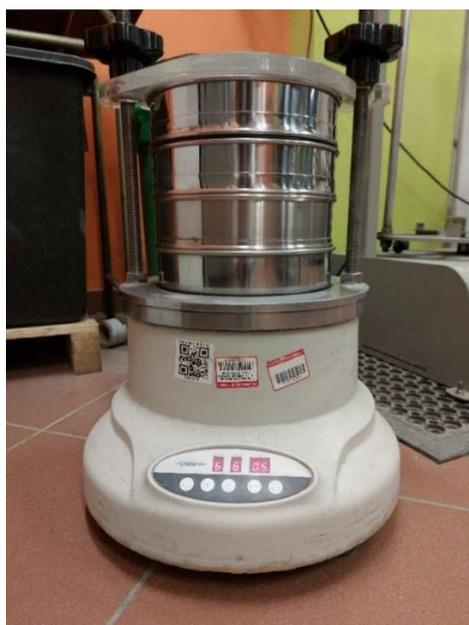
*Figura 33. Setacciatrice meccanica utilizzata per la classificazione granulometrica dei campioni in laboratorio.*
