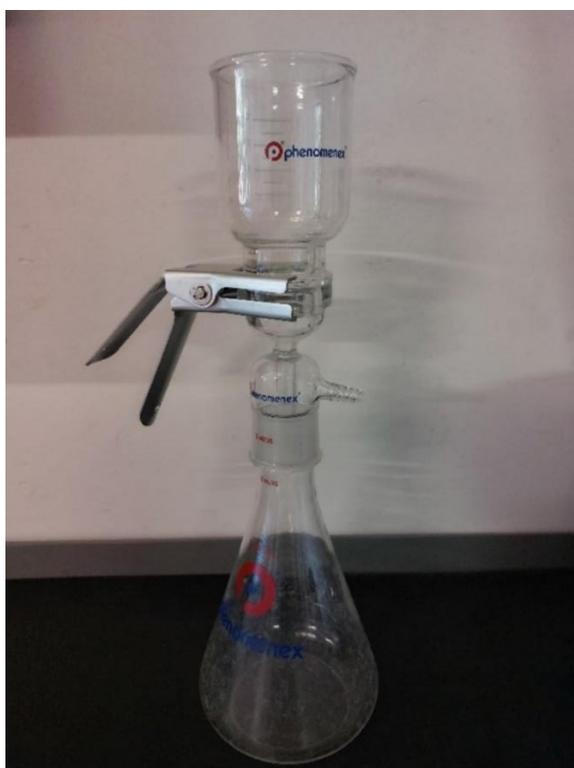
*Figura 40. Apparato di filtrazione a vuoto utilizzato in laboratorio per la filtrazione del supernatante.*
