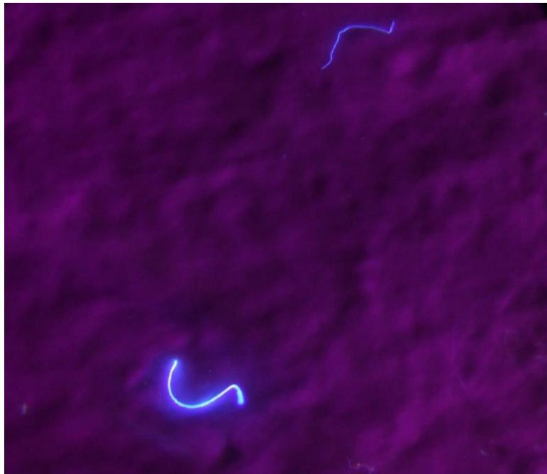
*Figura 52. Una fibra tessile naturale (in alto) e una fibra sintetica (in basso), che è caratterizzata da diametro regolare, superficie uniforme ed estremità tondeggianti.*
