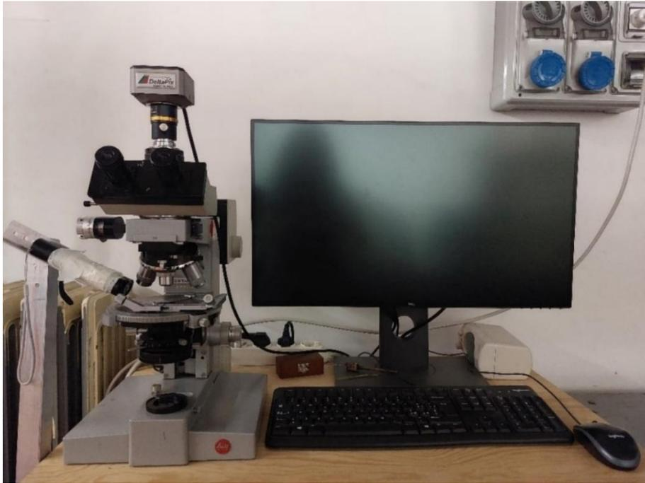
*Figura 46. Microscopio ottico utilizzato in laboratorio.*
