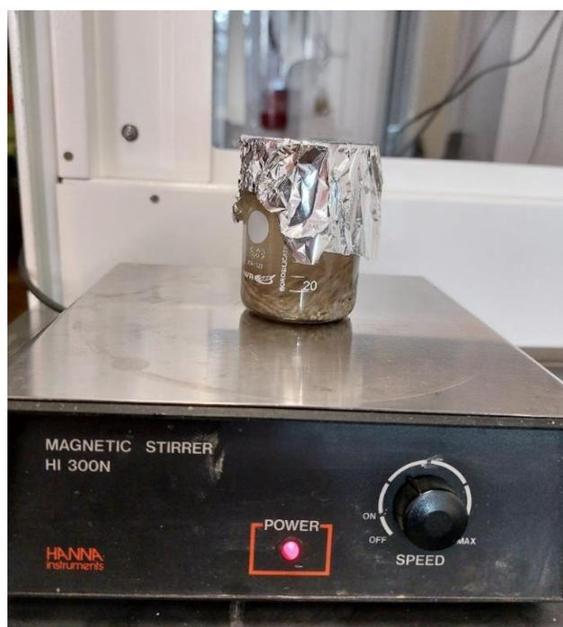
*Figura 37. Miscelazione, tramite agitatore magnetico, dei sedimenti sabbiosi in soluzione con il perossido di idrogeno (15%).*
