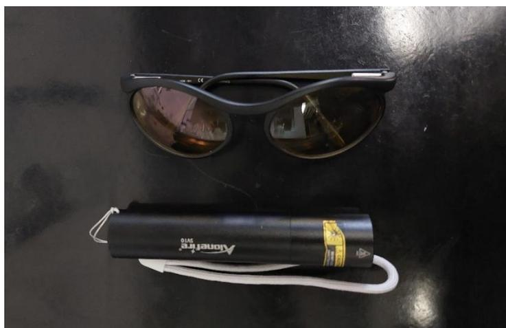
Figura 43. Torcia a luce UV ed occhiali protettivi utilizzati durante l'acquisizione delle foto sui filtri.
