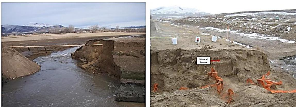
Figura 3-17 – Cedimento dell'argine lungo il canale Truckee, Nevada (Taccari, 2015)
